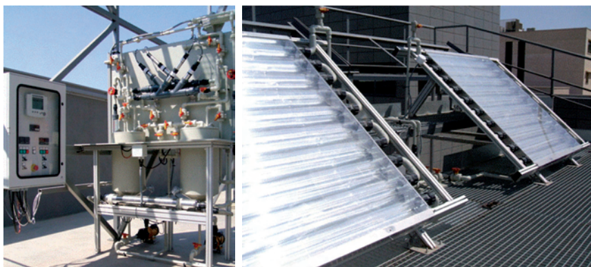
Foto 1. Planta piloto para experimentación de foto-Fenton.
