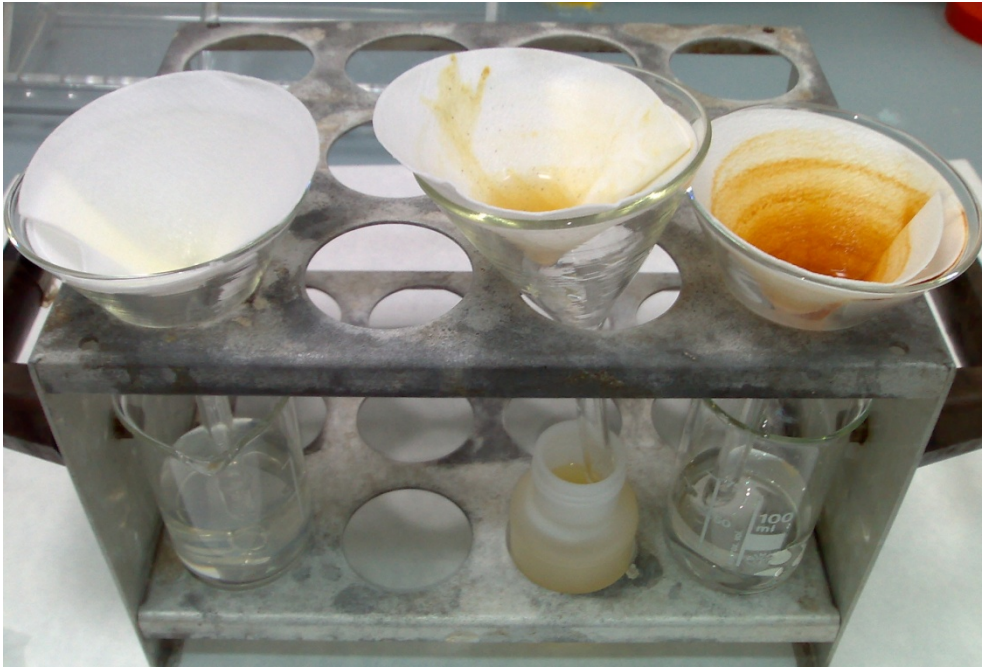
Figura 10: Aspecto de la filtración del agua tratada a 40 V, con electrodos de hierro.
