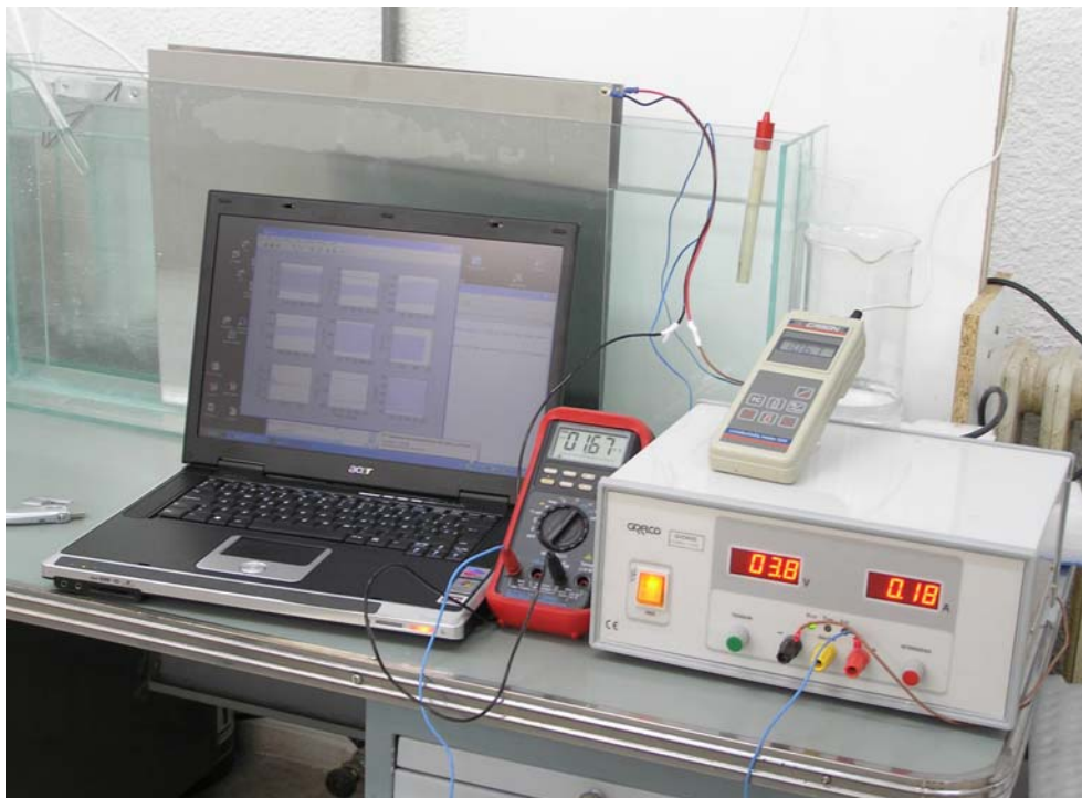
Figura 6.1. Dispositivo experimental de electrocoagulación de aguas
