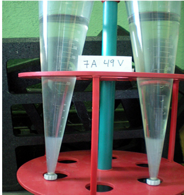
Figura 7.3. Agua clarificada procedente de la celda de aluminio
