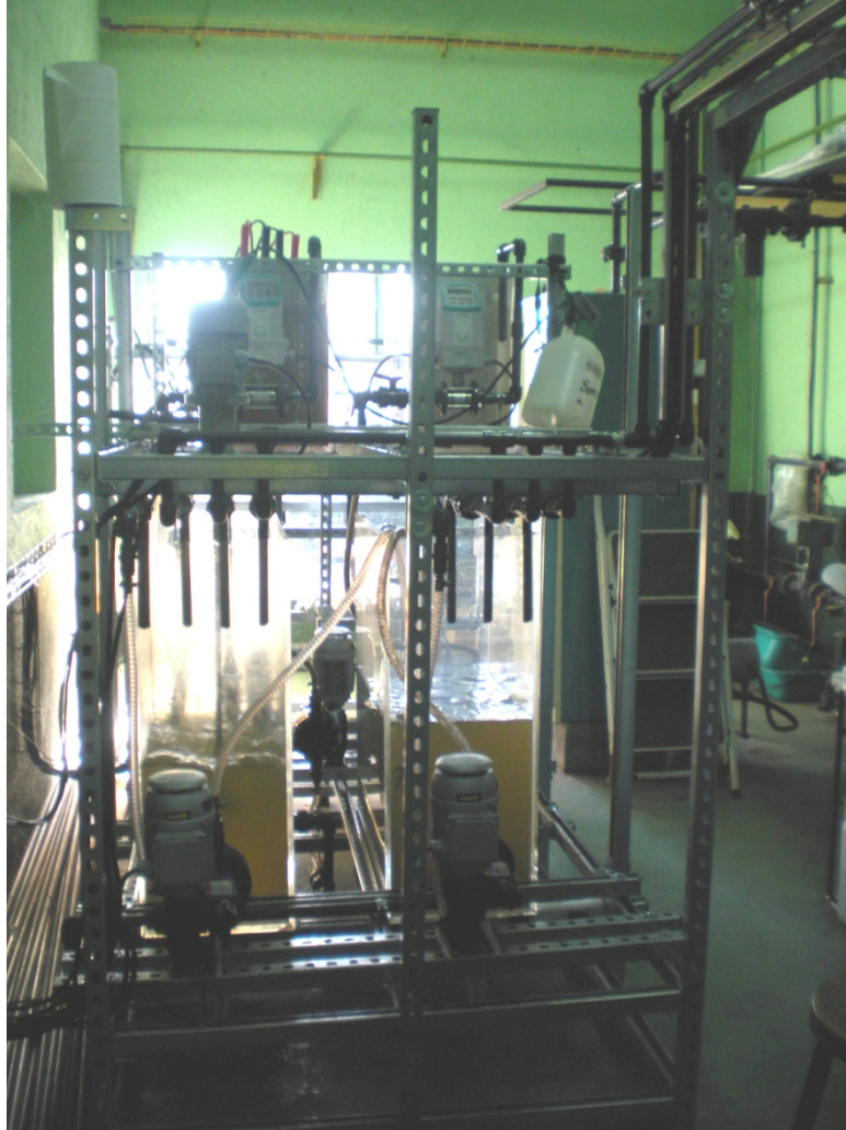
Figura 6.6. Vista parcial de la planta piloto de electrocoagulación
