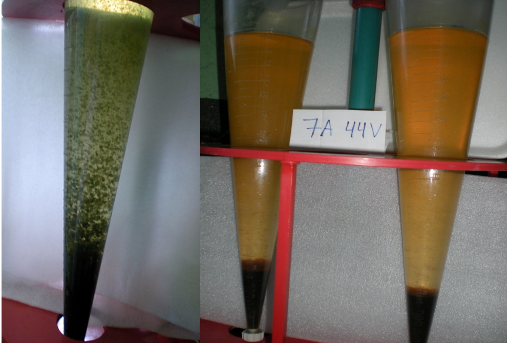
Figura 7.4. Efluente procedente del electrocoagulador de hierro. El primero a los 3 minutos de decantación y los segundos a los 30 minutos de decantación
