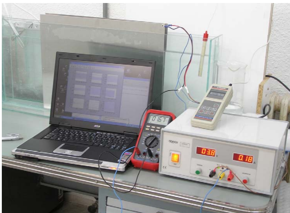
Figura 1.- Dispositivo experimental de electrocoagulación de aguas.
