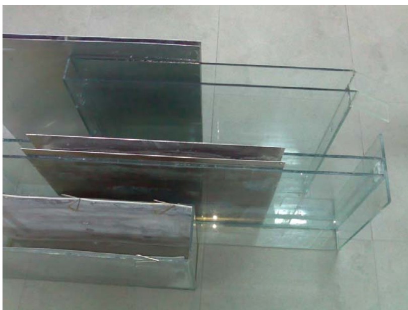
Figura 2.- Electrocoaguladores de 10, 3, 4 y 1 cm de separación de placas.
