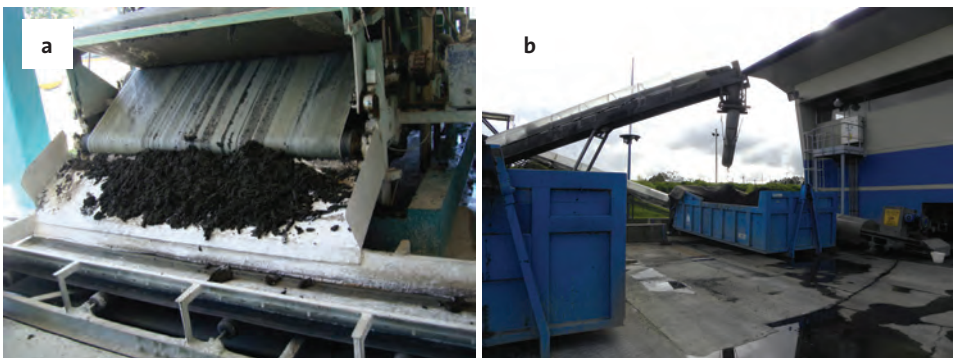
Figura 1.18. a) Filtro banda de la planta de tratamiento de aguas residuales Sur, Querétaro, México, b) Manejo de lodos residuales de la planta de tratamiento de aguas residuales de la Calera, Colombia.
