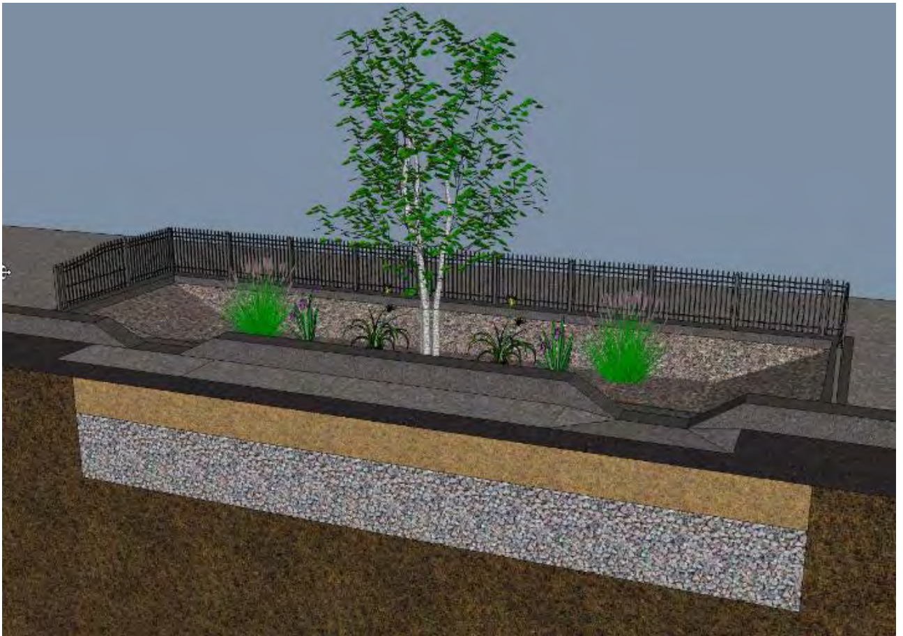
Zanja de infiltración
