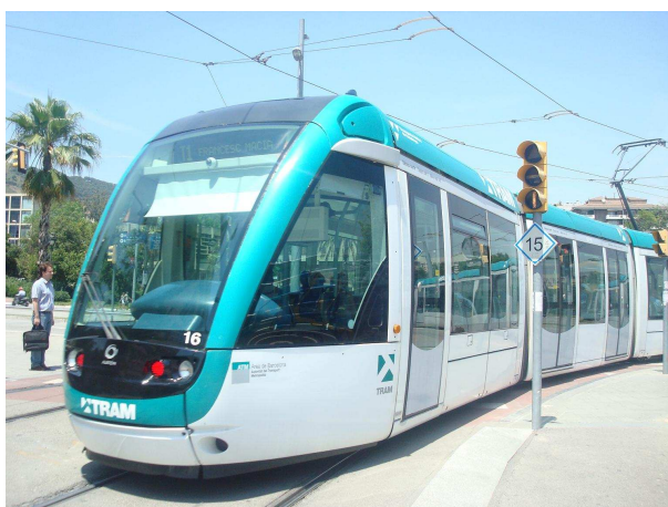
Foto 3.3 Curva sin peraltar de radio 30 m en la que velocidad se limita a 15 km/h, Barcelona. (Fuente propia)
