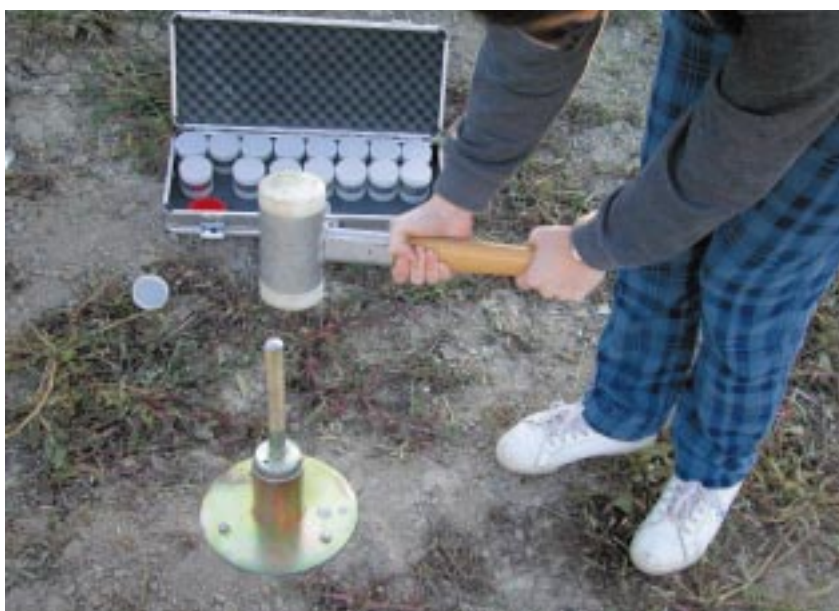
Foto 7.3 Toma de muestras inalteradas para la determinación de las características físicas del suelo.
