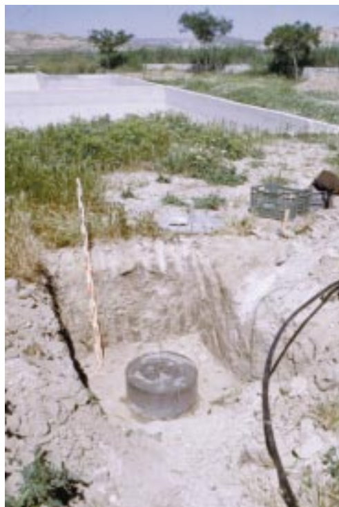
Foto 7.2 Medida de la capacidad de infiltración mediante la técnica de infiltrometro de doble anillo. Esta técnica presenta entre otras ventajas la posibilidad de situar el infiltrometro directamente sobre el estrato que va a servir de lecho de la balsa de infiltración.
