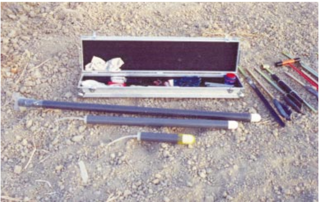
Foto 7.8 Equipo de muestreo de la solución del suelo mediante cápsulas cerámicas de succión.
