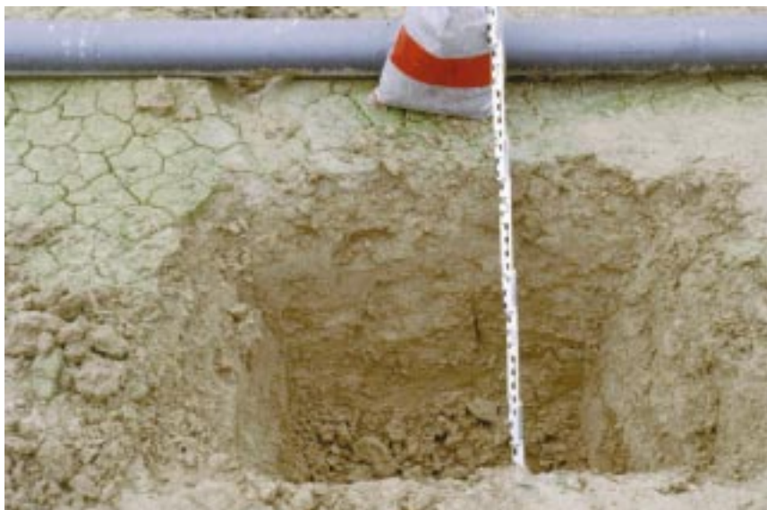
Foto 7.9 Toma de muestras del lecho filtrante mediante la apertura manual de catas.
