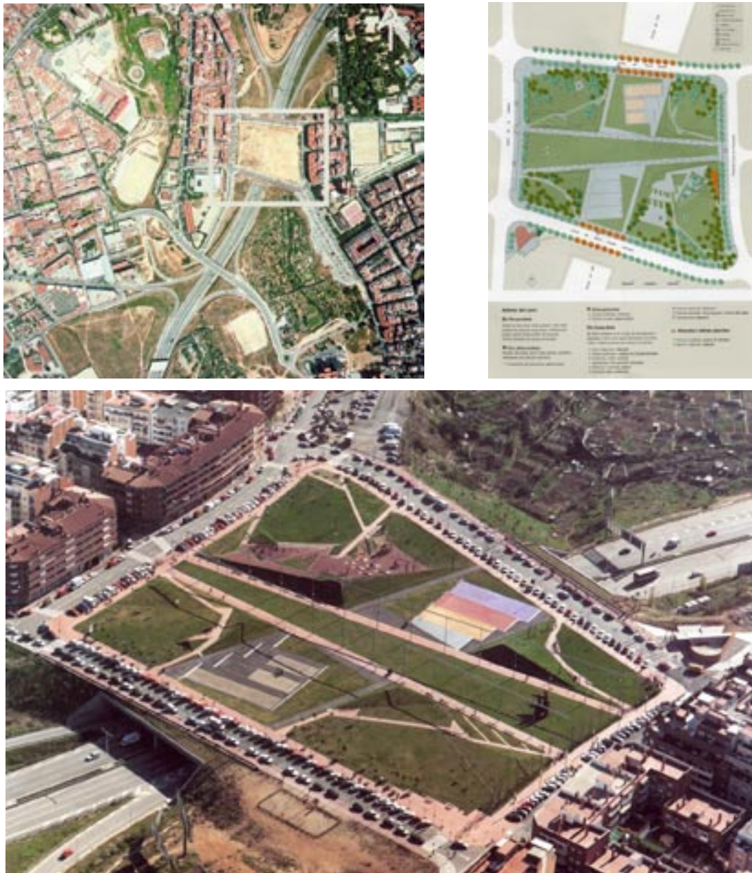
Figure 102-104. Parc de la Solidaritat. Foto e veduta aerea del parco che unisce i due quartieri separati dal sistema infrastrutturale. A destra in alto planimetria di progetto del parco dove si osserva la fascia centrale che riporta il segno della strada interrata.
