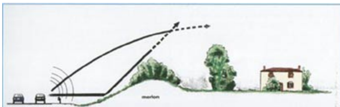
Figura 64. Soluzione adottata per l'abbattimento del rumore in prossimità delle abitazioni lungo l'A89
