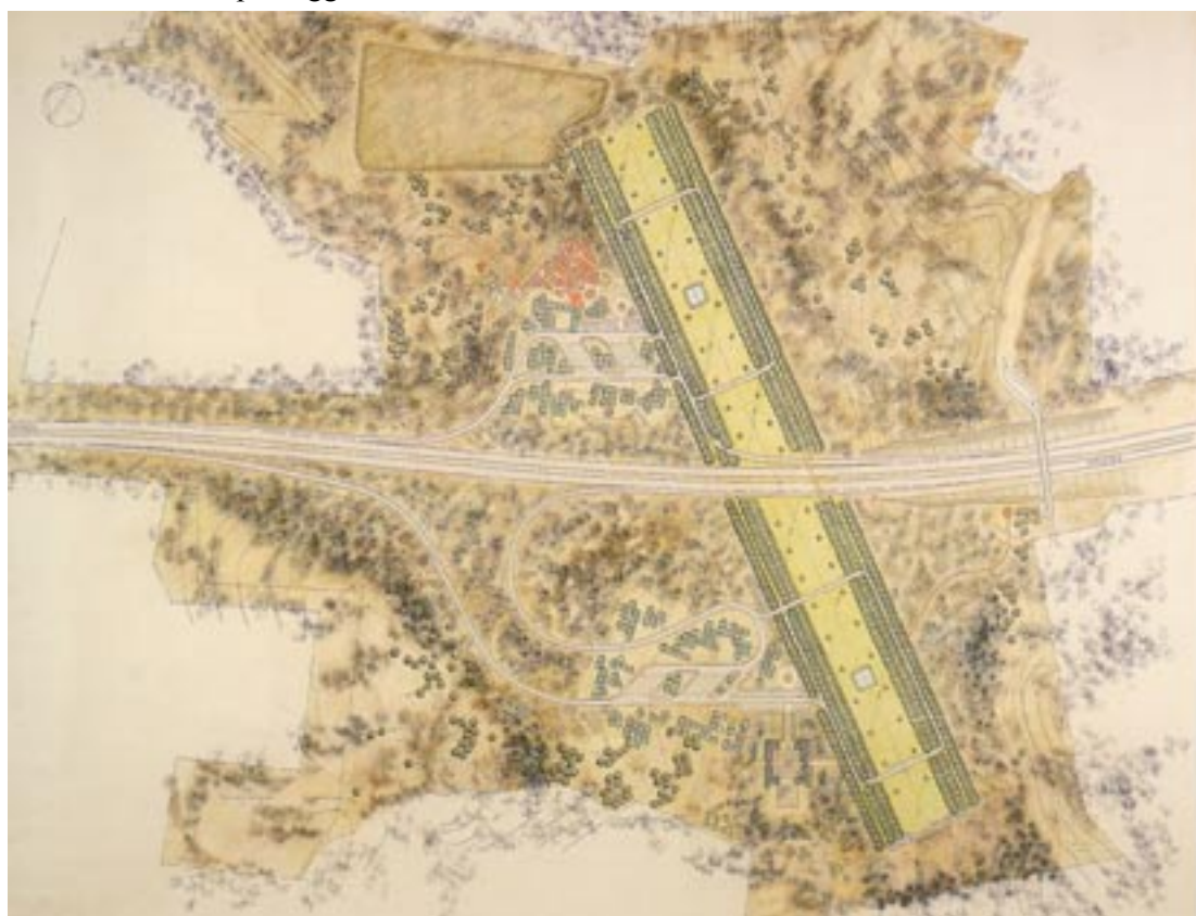
Figura 60. Area di sosta di Nîmes-Caissargues. Un grande viale attraversa l'autostrada in modo da indebolirne il segno.
