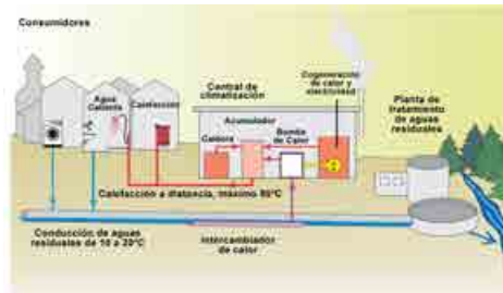
Figura 9. Esquema de la implantación de una instalación de intercambio para una instalación centralizada de climatización. Fuente: ENERES/KASAG.
