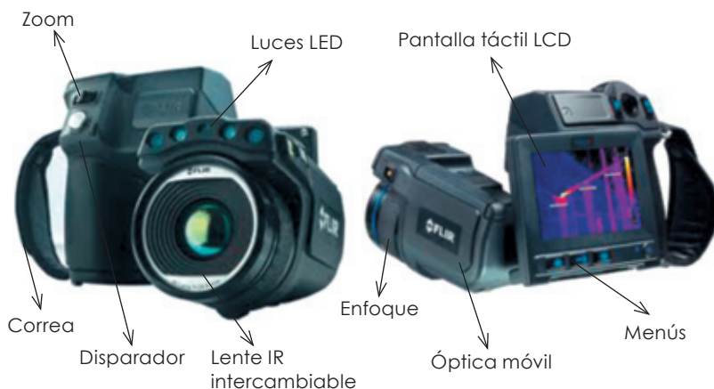
Figura 4. Cámara termográfica y partes de la misma (Flir Systems y eBuilding).
