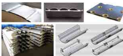
Figura 14. Distintas técnicas de fabricación, soldadura lineal, soldadura y soplado, y soldadura por puntos en la fabricación de intercambiadores de calor acero inoxidable, para aguas residuales. Construcción modular de las secciones, y ensamblaje. Fuente: ENERES/KASAG.
