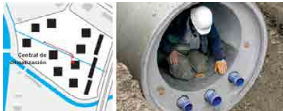
Figura 30. Mapa de la zona: en Línea azul principal de agua residuos, en rojo, bypass con el intercambiador calor Sala de calderas. Fuente: ENERES/KASAG.
