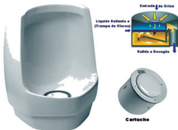
Foto 9. Urinario sin agua, cartucho y explicación de la trampa de olores
