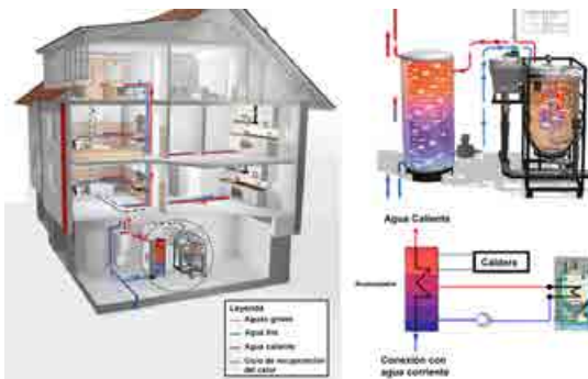
Figura 6. Instalación doméstica de un sistema combinado de recogida y tratamiento, y extracción de energía residual de las aguas grises. Fuente: PONTOS GmbH/Hansgrohe AG.
