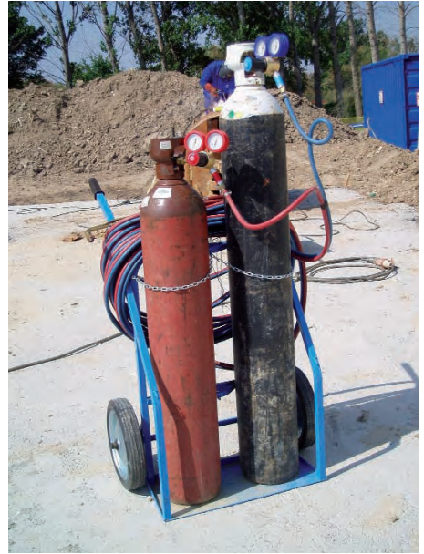
Equipo de soldadura y oxicorte.
