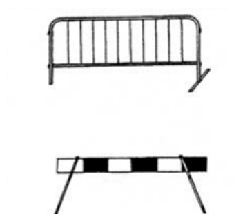
Ilustración 18 Vallado de señalización. Fuente: http://www.ibermutuamur.es/
