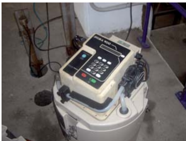
Muestreador en continuo para la obtención de muestras compuestas (Foto G. Espinosa)
