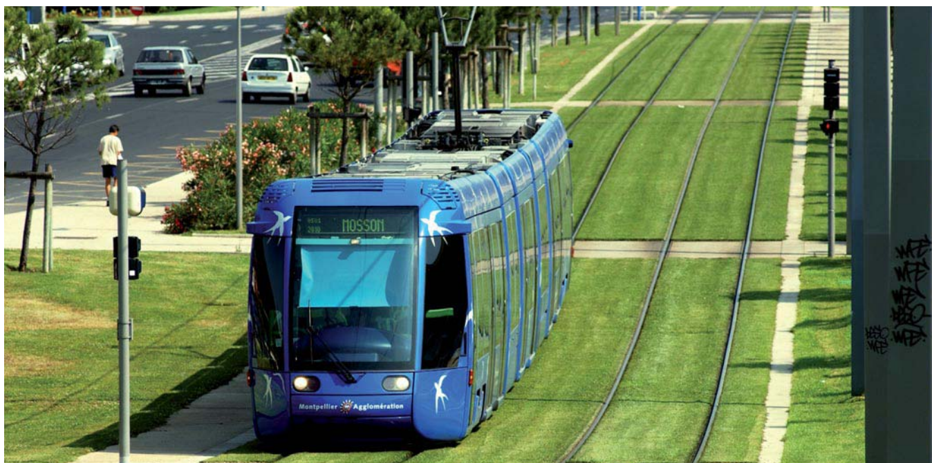
Fig. 8. En sistemas con contacto rueda-carril debido a la falta de adherencia no es aconsejable plantear rampas superiores al 6-7%. En tramos largos es conveniente limitarlas al 4%. Fuente: Fondo documental del Consorcio Regional de Transportes de Madrid.
