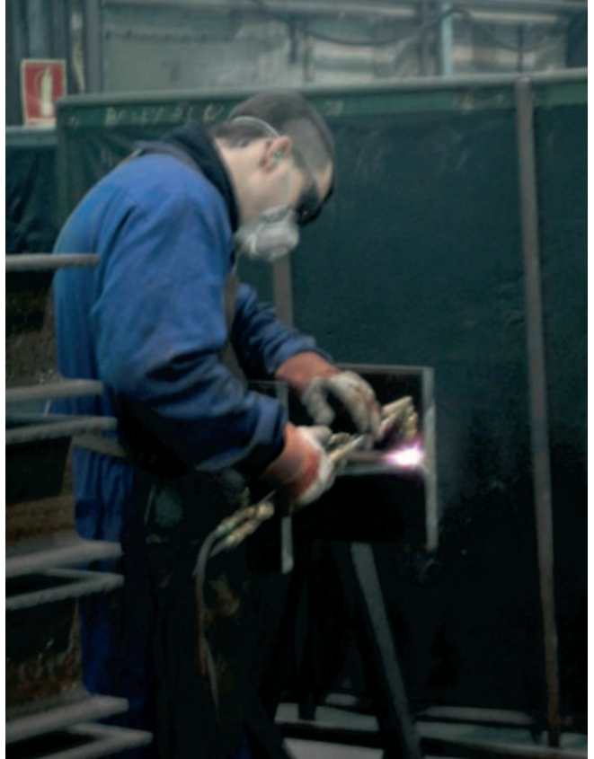
Figura 28. Operación de oxiacorte. El soldador va protegido con gafas tipo cazoleta.
