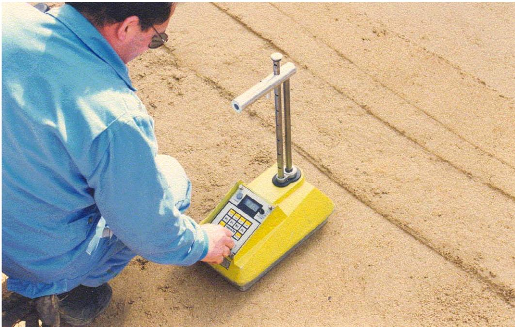
**Figura 4.11** Comprobación del grado de compactación mediante aparato nuclear (Troxler).
