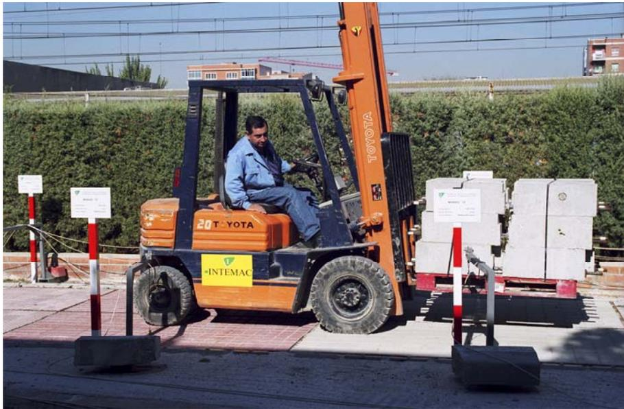
Figura 4-44. Vista de la carretilla elevadora desplazándose por el tramo experimental.
