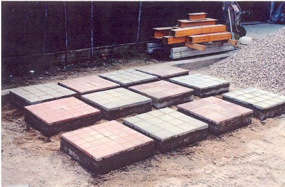
**Figura 3.7 Acabado de los módulos de prueba de 62x60 cm tras enlechado y tableado.**
