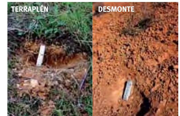
Figura 5. Diferencias en la estructura del suelo de terraplenes y desmontes de la Autovía A-3 a la altura de Requena (Valencia). En los primeros centímetros de profundidad, el nivel de compactación del suelo es mayor en los desmontes. El aporte de materia orgánica al suelo por las plantas (hojarasca y raíces) confiere una mayor estructura al suelo de los terraplenes (Foto: Esther Bochet).
