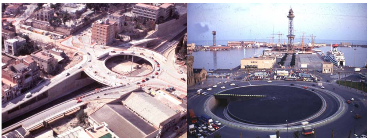
Fig. 6.4: Plaça Borràs en fase de construcción y Plaça de la Carbonera antes de la construcción del “World Trade Center” ambas en Barcelona, conectadas con la Ronda de Dalt y la Ronda Litoral, respectivamente. Las dos son claros ejemplos de cómo las rotondas generan puntos donde los vehículos pueden “emerger” a la superficie y conectar con la trama de la ciudad a partir de una vía de ronda situada a distinto nivel.
