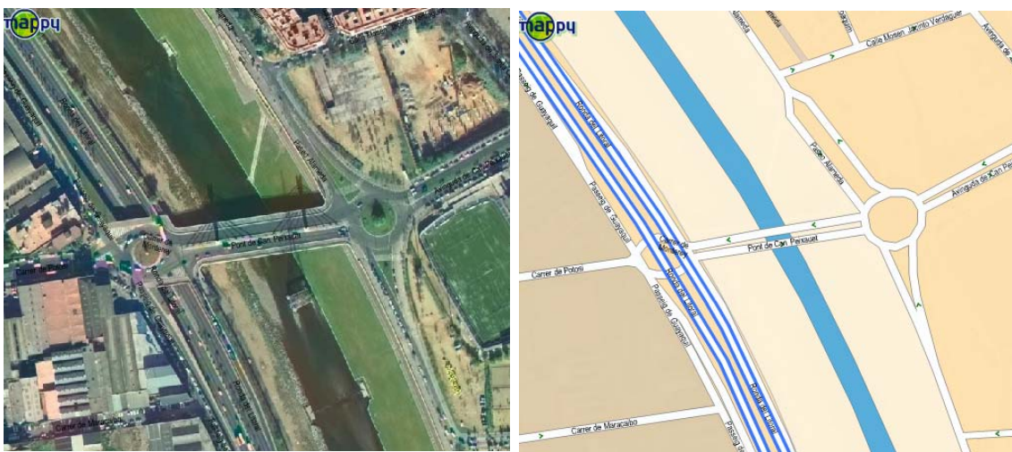
Fig. 5.34: Doble rotonda sobre el Besòs, entre Barcelona y Santa Coloma de Gramanet.
