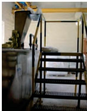
En la figura 077, podemos ver como colocando una plataforma entre la tolva y la escalera, reducimos el impacto sobre la espalda del trabajador a la hora de dosificar, ya que esta plataforma permite apoyar el saco en ella y descargar la espalda.
