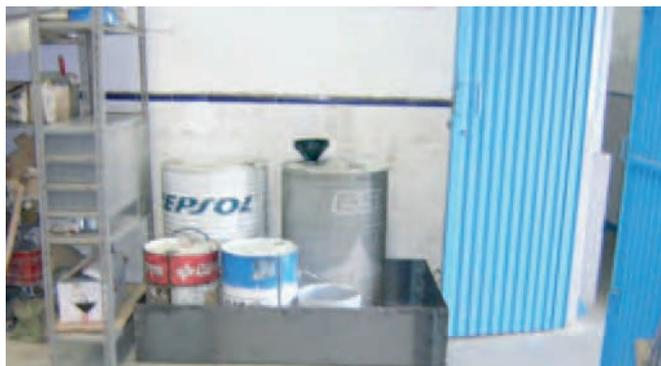
Los cubetos de plástico (polietileno) y acero inoxidable son resistentes a la corrosión y por tanto necesarios para contener derrames de medios agresivos.
