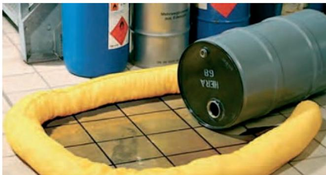
*Figura 163. Utilización de productos absorbentes en derrame de contenedor.*
