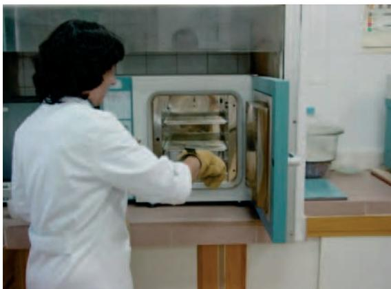
*Figura 026. Utilización de guantes de protección térmica en el uso de un horno de laboratorio.*
