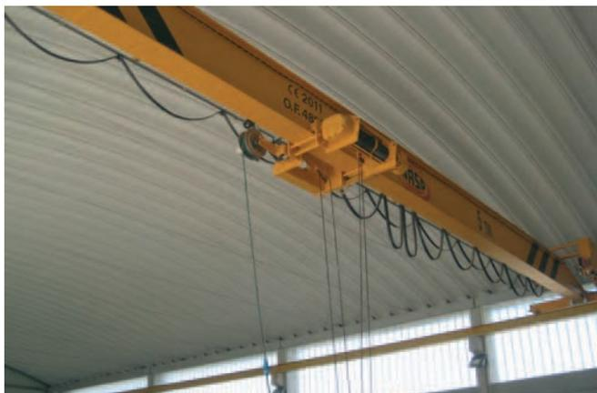
Por último, destacar que en la inmensa mayoría de plantas, existen polipastos o equipos similares junto a aquellos equipos sumergidos y que se deben sacar periódicamente para tareas de mantenimiento o reparación. (figura 067).
