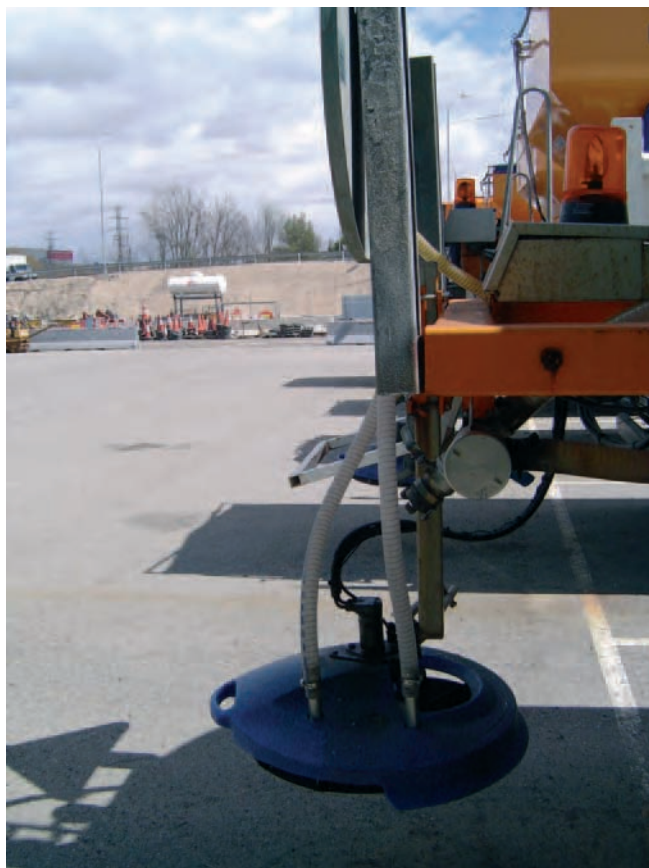
Figura 83. Detalle del equipo para el esparcido de salmuera montado en la parte trasera del vehículo.
