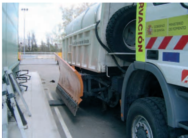
Figura 88. Vehículo esparcidor de salmuera con cuchilla lateral para apartar la nieve acumulada en el arcén, por la pasada de la cuchilla delantera.
