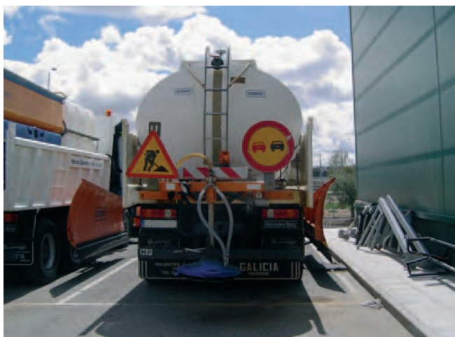
Figura 91. Detalle de un vehículo para el esparcido de la salmuera, se puede observar la cisterna, la señalización del vehículo en la parte trasera, las mangueras de alimentación del producto, el esparcidor, así como una cuchilla lateral orientable para apartar, en caso necesario, la nieve del arcén.
