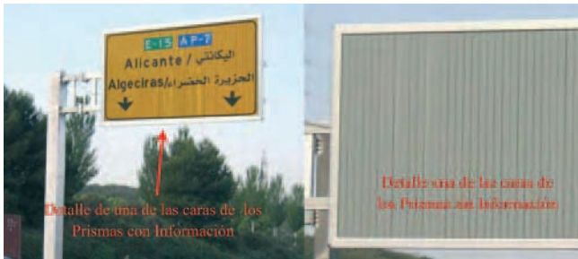
Figura 46. Panel de Información Variable a base de Prismas triangulares. Detalle de una de las caras de los Prismas con Información y la otra sin Información.
