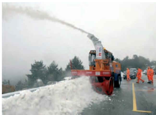
Figura 89. Otra manera de retirar la nieve acumulada, por el quitanieves en el borde del arcén es haciendo uso de un tractor al que se le acopla una especie de fresa que introduce la nieve en una tolva que la expulsa fuera de la calzada.
