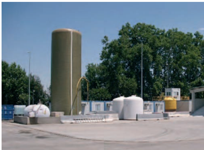
Figura 90. Detalle de una Planta para la elaboración de salmuera, dentro de una Base de Conservación.
