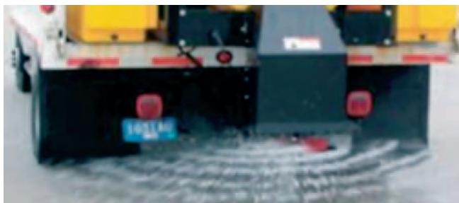
Figura 84. Detalle del proceso de esparcido de sal desde la tolva del vehículo.
