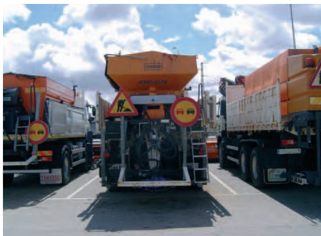
Figura 87. Vehículo preparado para la dispersión de sal.
