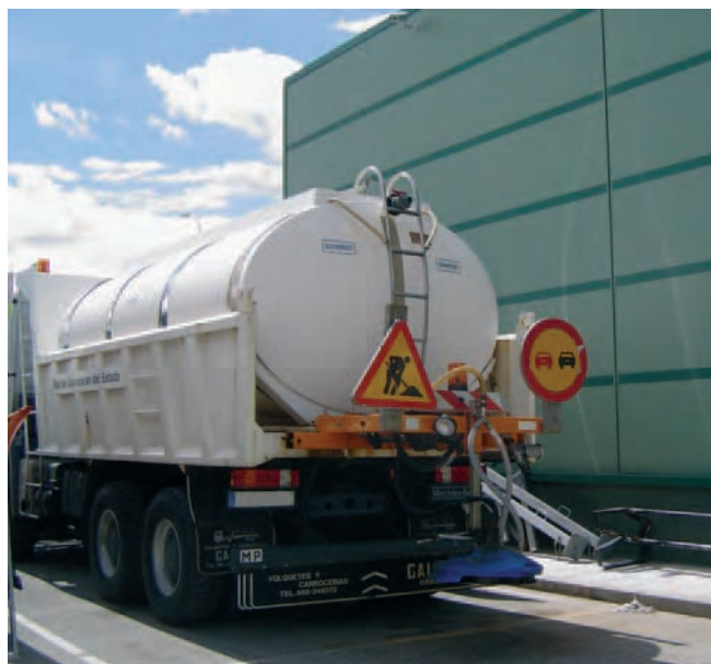
Figura 82. Vista trasera de un vehículo para el extendido y dispersión de salmuera.
