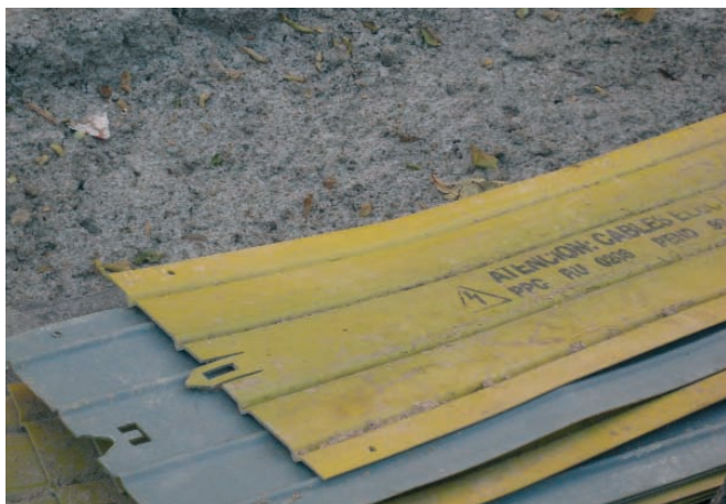
Figura 118. Protección rígida para cables desnudos.
