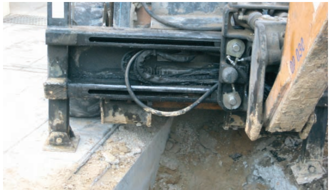
Figura 057. Apoyo sobre dos superficies de diferente resistencia.
