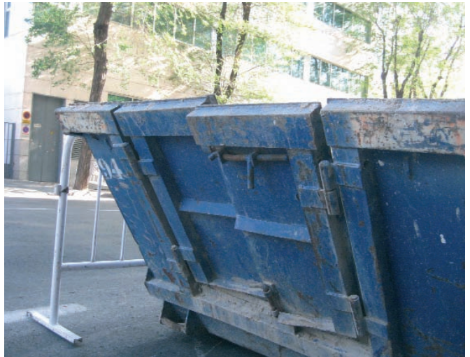
Figura 087. Contenedor con la trampilla cerrada.
