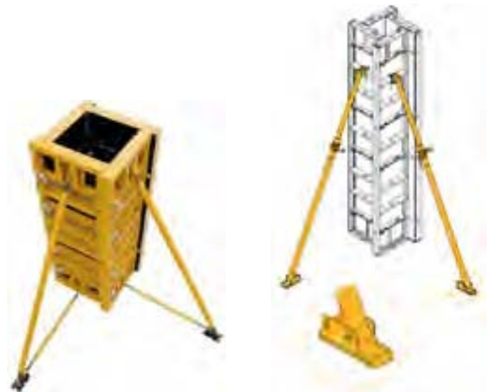
Fig. 36 – Detalle de puntales de estabilización
