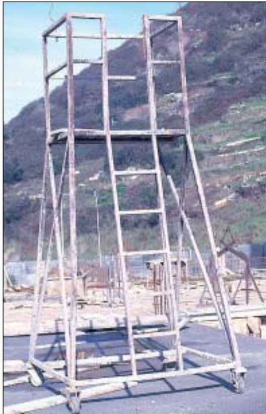
Plataforma para hormigonado de pilares
