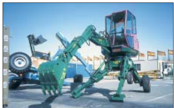
Retroexcavadora ligera con 2 ruedas y 2 patas articuladas, que emplea el propio cucharón como otra pata más de apoyo para los desplazamientos, posibilitando su trabajo en lugares de configuración diversa
