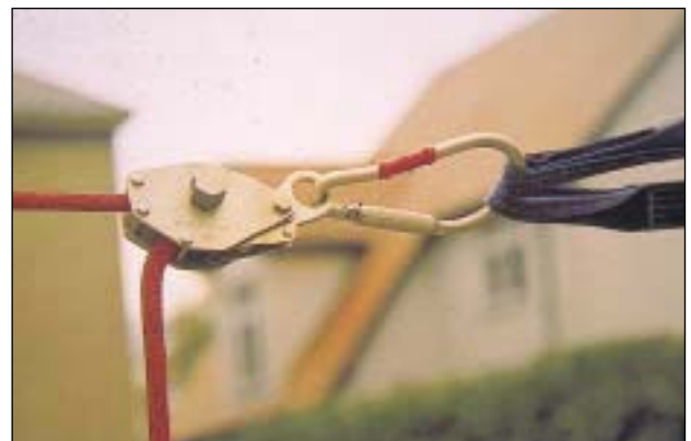
Sistema de seguridad (línea de vida) que permite el movimiento del usuario en tres direcciones
