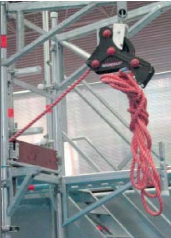
Polea de montaje con freno de seguridad
