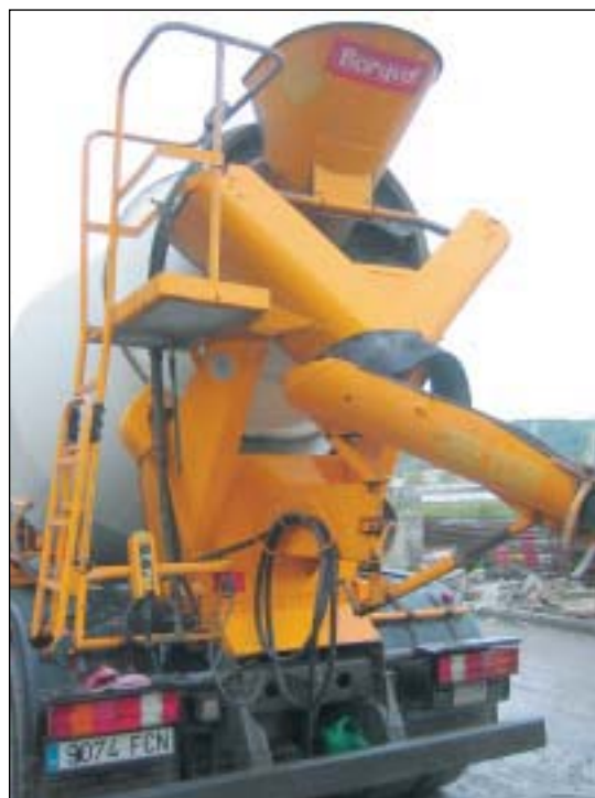
Escalera de acceso a la tolva
