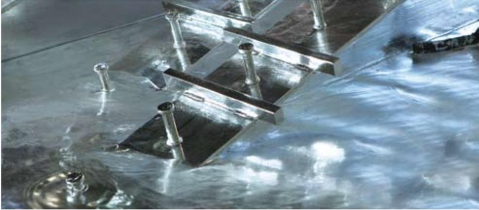
Actualmente, la protección anti-corrosión se suele realizar a menudo galvanizando la estructura metálica mediante inmersión en caliente. Antes de la galvanización, el óxido y la calamina se eliminan mediante un baño de ácido. Durante la inmersión en el baño de zinc líquido a 450° C, se forma bajo la capa de zinc una aleación adherente de hierro-zinc.
