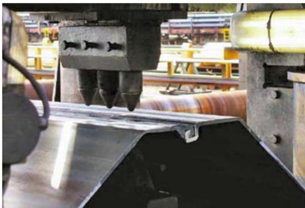
*Figura 88: Fijación mecánica de las juntas*
