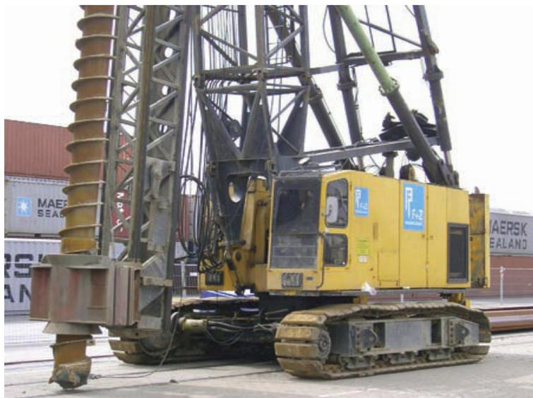
*Figura 35: Máquina de perforación helicoidal*
