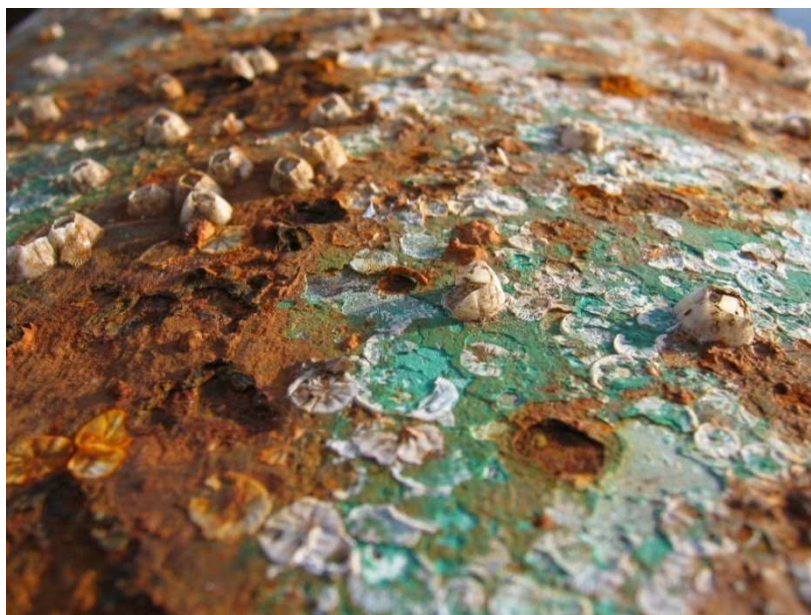
Fig. 1.6. Ilustración del acero corroído por picadura (verosanhue.blogspot.com; 12 Marzo 2011)
