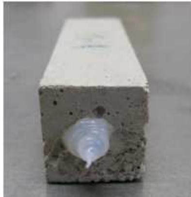
Fig. 2.3. Recubrimiento de silicona de la parte exterior del alambre
