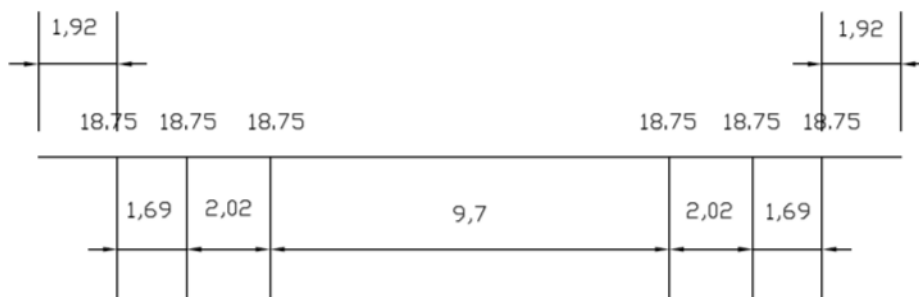
Figura 12. 201 CLASS. Locomotora [Cargas en t y longitud en m]. (Irishrail (2011))
