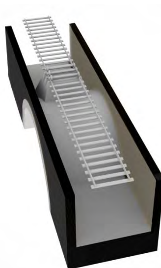
Figura 3. Esquema resistente longitudinal en un puente arco de fábrica. (Martín-Caro, 2013)
