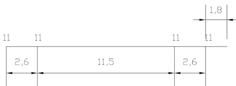
Figura 11. TREN TIPO 1. Tren de pasajeros. Vagones [Cargas en t y longitud en m]. (Irishrail (2011))
