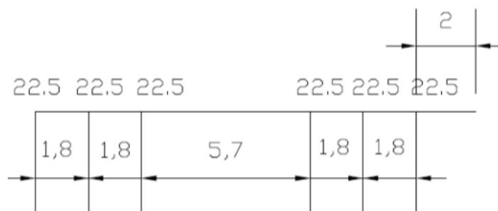
Figura 17. TREN TIPO 5. Tren de mercancías. Vagones [Cargas en t y longitud en m]. (Irishrail (2011))
