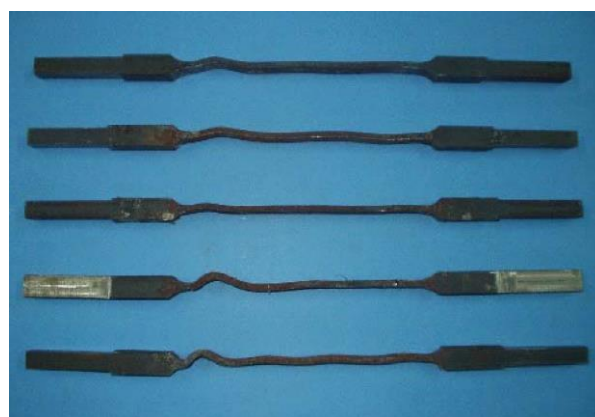
Fig. 6-8. Vista del núcleo de acero de riostras de pandeo restringido ensayadas por Palazzo et al. (2009).
