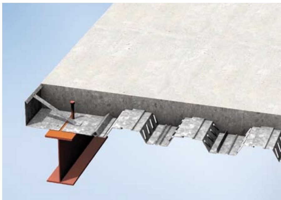
Figura 3.1 Viga de borde en forjado mixto
