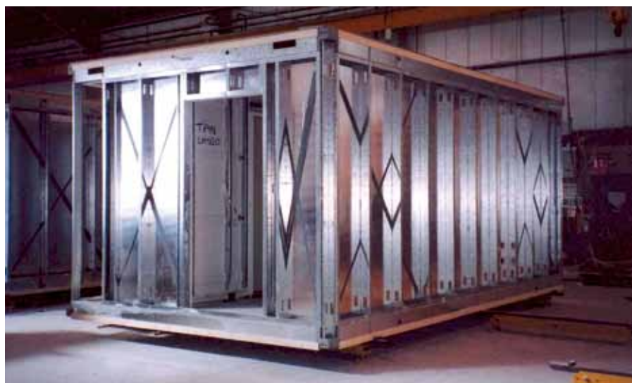
Figura 6.2 Módulo cerrado autoportante Fuente: Terrapin
