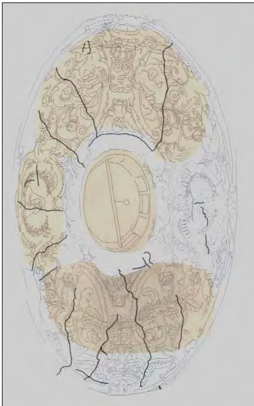
Figura 6.3.1 Cúpula del Evangelio en la Iglesia de la Mantería en Zaragoza. Replanteo de las fisuras sobre los frescos de Claudio Coello
