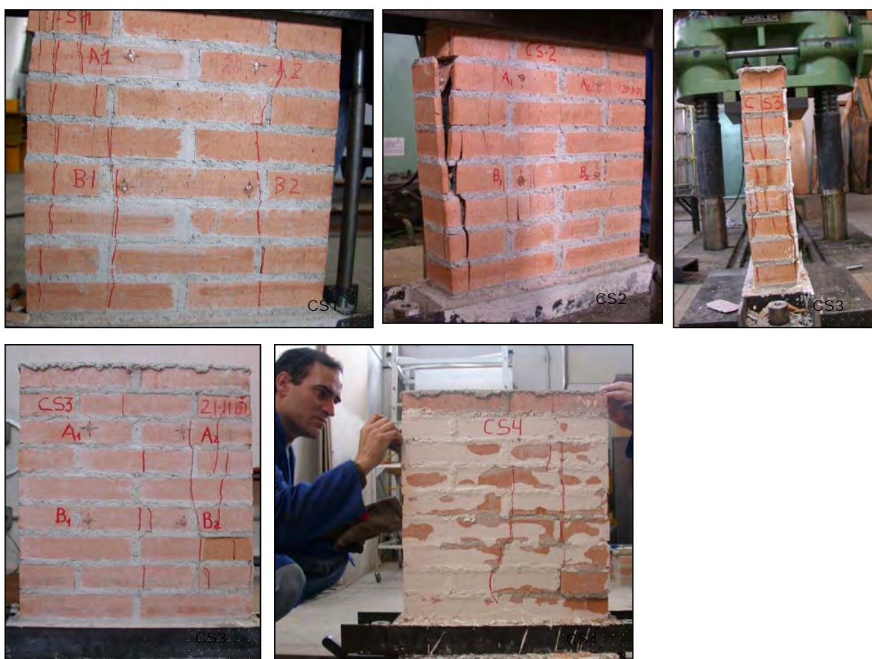
Figura 4.26 Roturas de la serie CS. CS1 con fisuración predominante en la zona de cuarto del ancho y concentración de daño en el extremo A1-B1. CS2 muestra el modo de fallo por separación de la pared lateral. CS3 Vista lateral del extremo A2-B2 y vista fronta; la fisuración siempre vertical, se localiza en una mitad de la probeta. CS4 visto por la cara posterior que fue blanqueda; se aprecia el desprendimiento de la capa de yeso.
