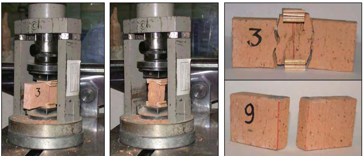
Figura 4.19 Primera fisuración y rotura a compresión de la probeta 3. Aspecto de las probetas 3, ensayada hasta rotura, y 9, ensayada hasta fisuración
