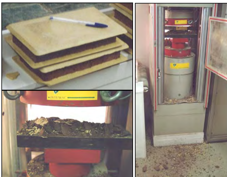
Figura 4.1 Ensayo a compresión simple de los ladrillos macizos y rotura explosiva
