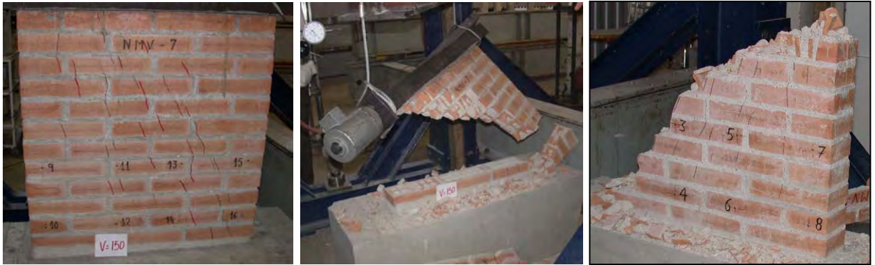
Figura 4.43 Fisuración en rotura y colapso frágil de los ensayos NMV 7, izquierda y centro, y 6, derecha. Modo III, sección crítica superior
