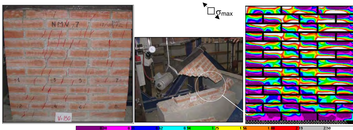
Figura 4.63 Rotura súbita de los ensayos NMV 6 y 7, y tensiones máximas de tracción del modelo elástico. El detalle muestra el pie íntegro del muro.
