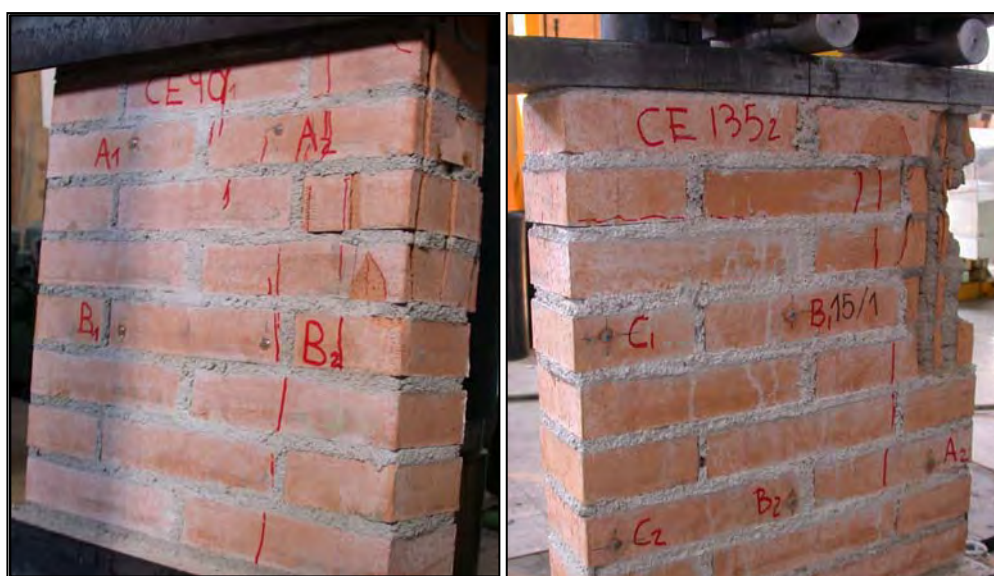
Figura 4.32 Rotura de muretes de excentricidades media y alta: CE90-1 y CE125-2. En la foto de la derecha se observa la fisuración paralela a los tendeles marcada sobre la base C
