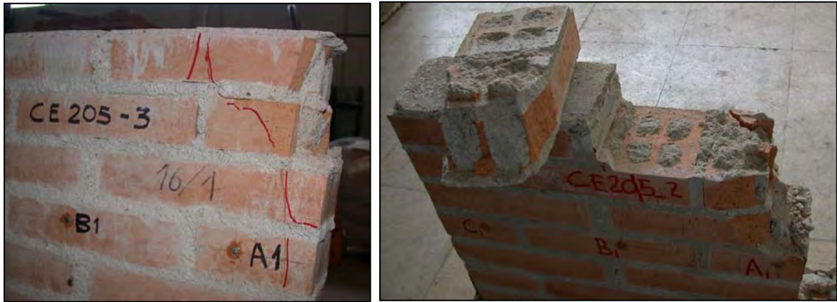
Figura 4.33 Rotura de los muretes CE205-3 y CE205-2. La fisuración vertical afecta a 4 ladrillos, mientras la fisuración horizontal de tracción se tiene inmediatamente junto a la zona comprimida. La mayor parte del muro no resulta dañada
