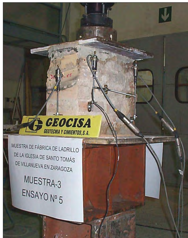
Figura 6.3.7 Ensayo de una de las muestras de fábrica obtenidas de la cúpula colapsada
