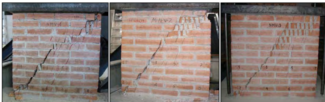
Figura 4.42 Ensayos NMV1, 2 y 3 de izquierda a derecha. Rotura diagonal con modo predominante II. Sección crítica superior
