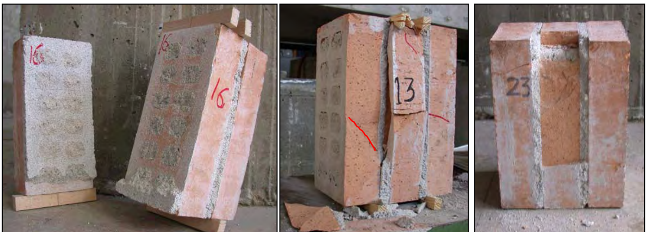
Figura 4.21 Roturas características. Modo I, deslizamiento, probeta 16 ( N=4.5 \text{ kN} ; V=27 \text{ kN} ). Modo II-III, rotura compuesta, probeta 13 ( N=200 ; V=110 ) y probeta 23 ( N=260 \text{ kN} ; V=114 )
