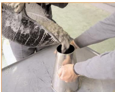
Este ensayo es el más utilizado debido a la sencillez, y a utilizar el mismo cono que se utiliza para el ensayo de asiento en cono de Abrams habitual.
