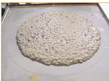
y el diámetro final del hormigón extendido, ensayo que debe repetirse si difieren los dos diámetros medidos en más de 5 cm.
