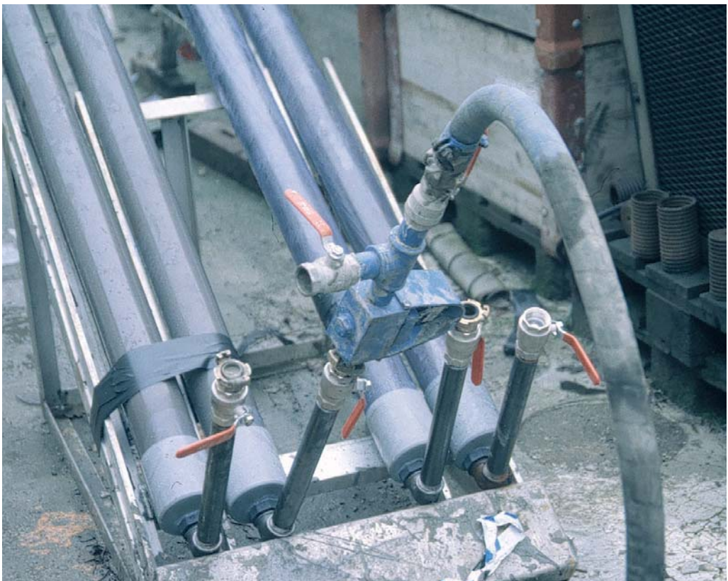
Figure n°6 : Dispositif d'essai de stabilité sur tube incliné
