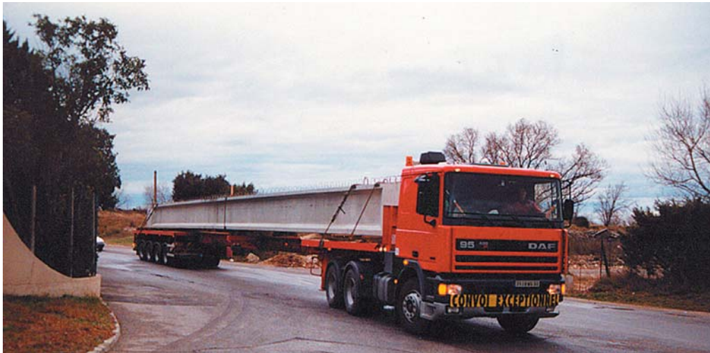
Transport de poutres
