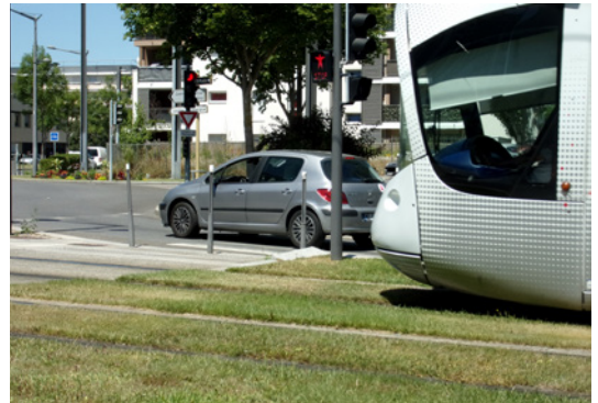
Photo 8 : gestion par signal R25 de la traversée de plateforme (source : Cerema)
