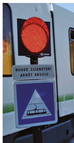
photo 14 : panneau associé au signal R24 et au C20c (source Semitan)
