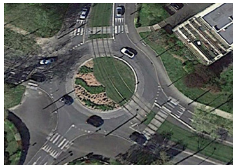
Photos 1 et 2 : exemples de traversée de giratoire par un tramway en site axial
