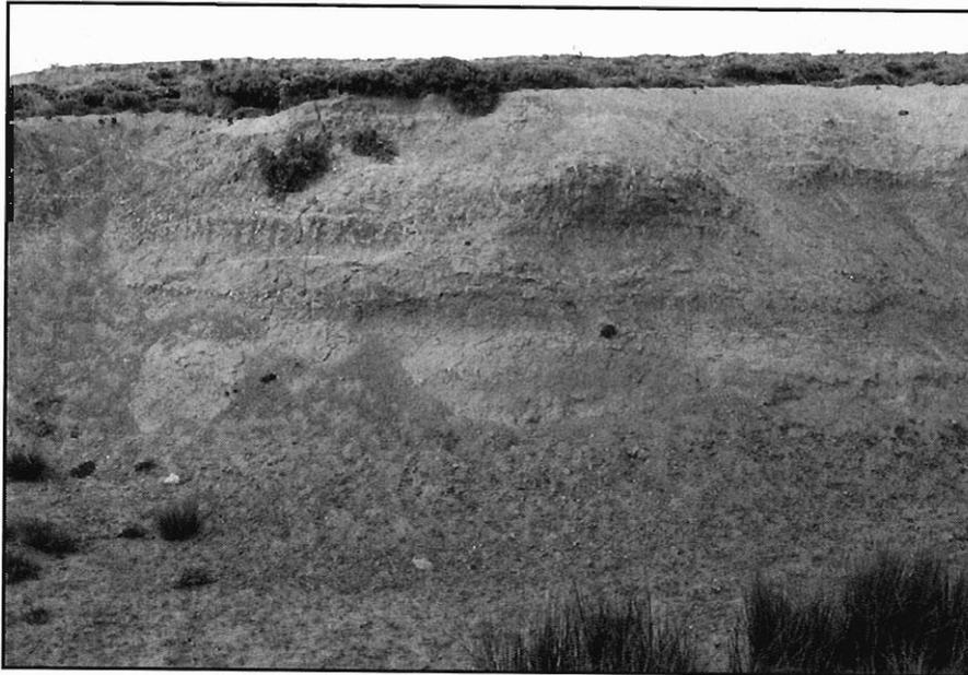
Figura 3.14.- Corte parcial en las arenas limo-arcillosas del grupo (32d). Se puede apreciar una cierta disposición en capas, así como la presencia de venas de carbonatos en el nivel superior. Proximidades de Aldehuela (Hoja 506-4).
