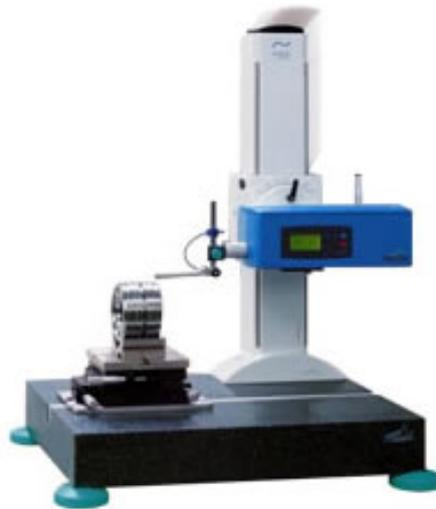
**Figura 4.1:** Perfilómetro para medida de rugosidad superficial.
