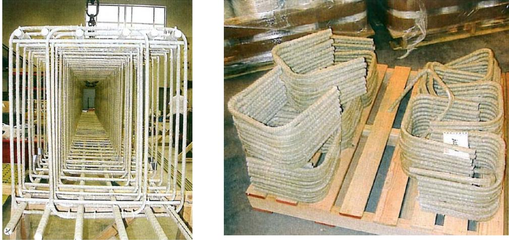
**Figura 3.30:** Barras de FRP para empleo en estructuras de hormigón.
