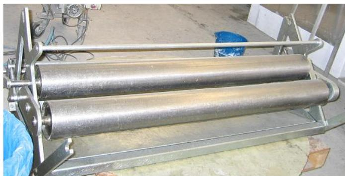
**Figura 3.9:** Máquina impregnadora eléctrica.
