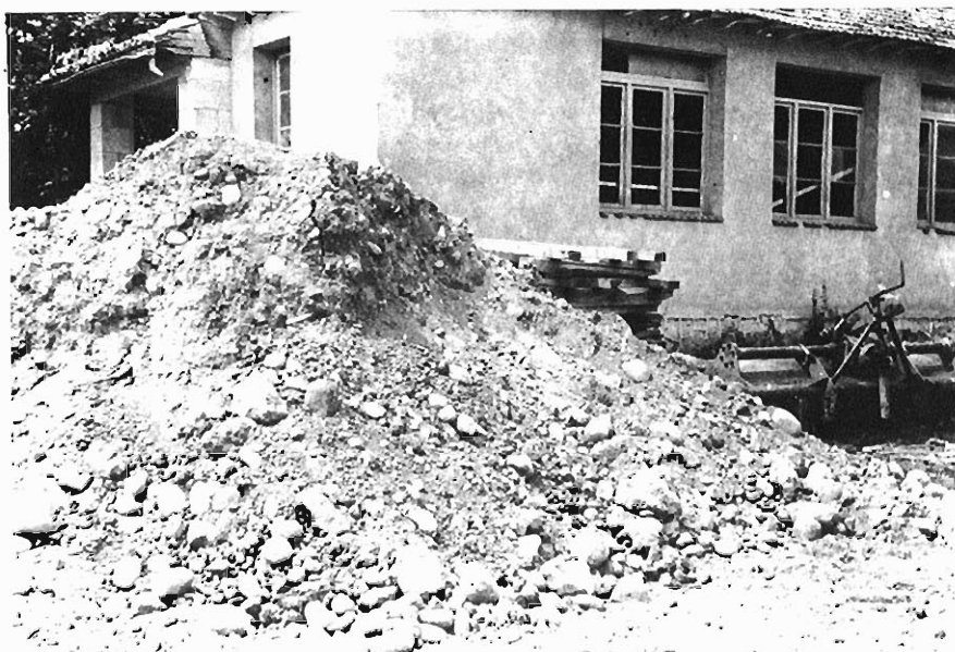
Foto 51.— Aspecto de los materiales que se han extraído en una pequeña excavación realizada en los materiales del grupo T1.
