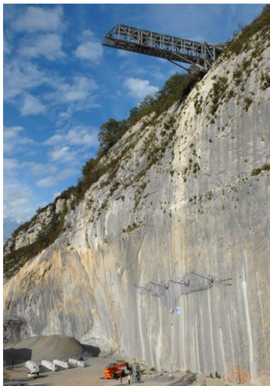
Figure 17. Station d'essais de chutes de blocs de lfsttar (Montagnole, Savoie. Source : lfsttar).
