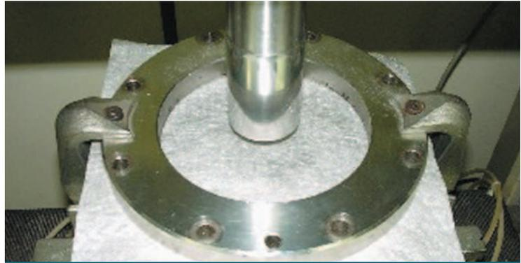
Ensayo de punzonamiento estático (CBR) de un geotextil no tejido.
