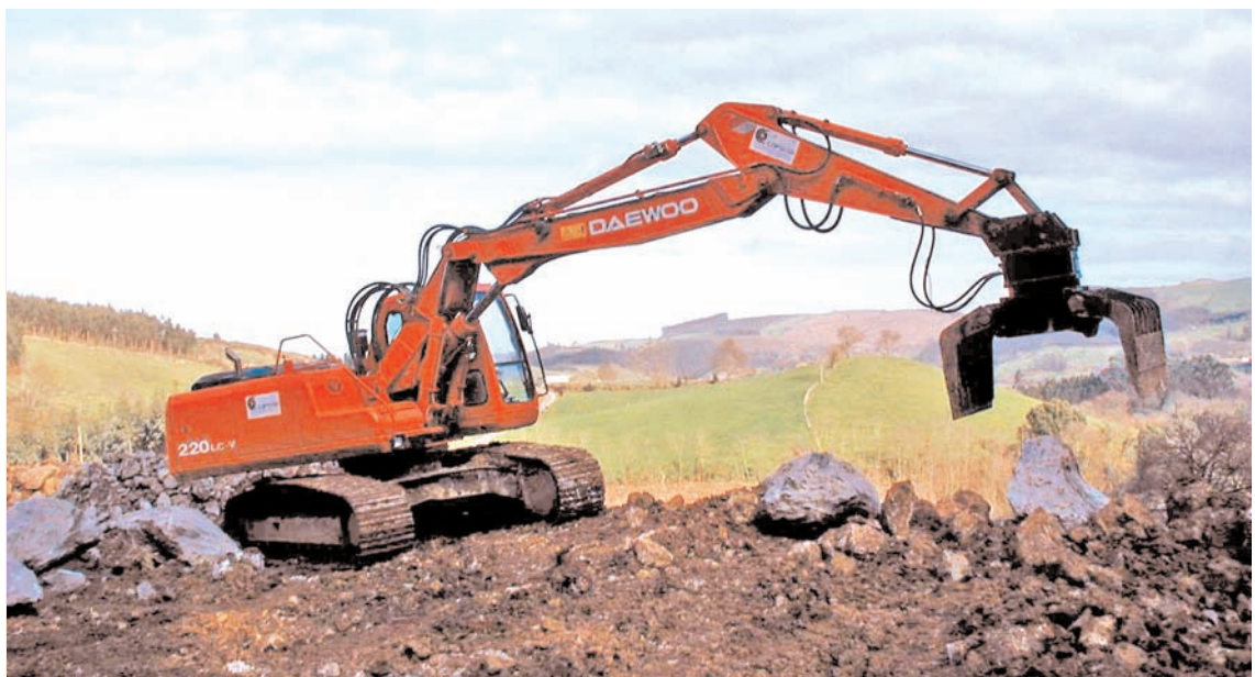
FIGURA A-1.3. PINZA DISPUESTA PARA COGER UN BLOQUE.
