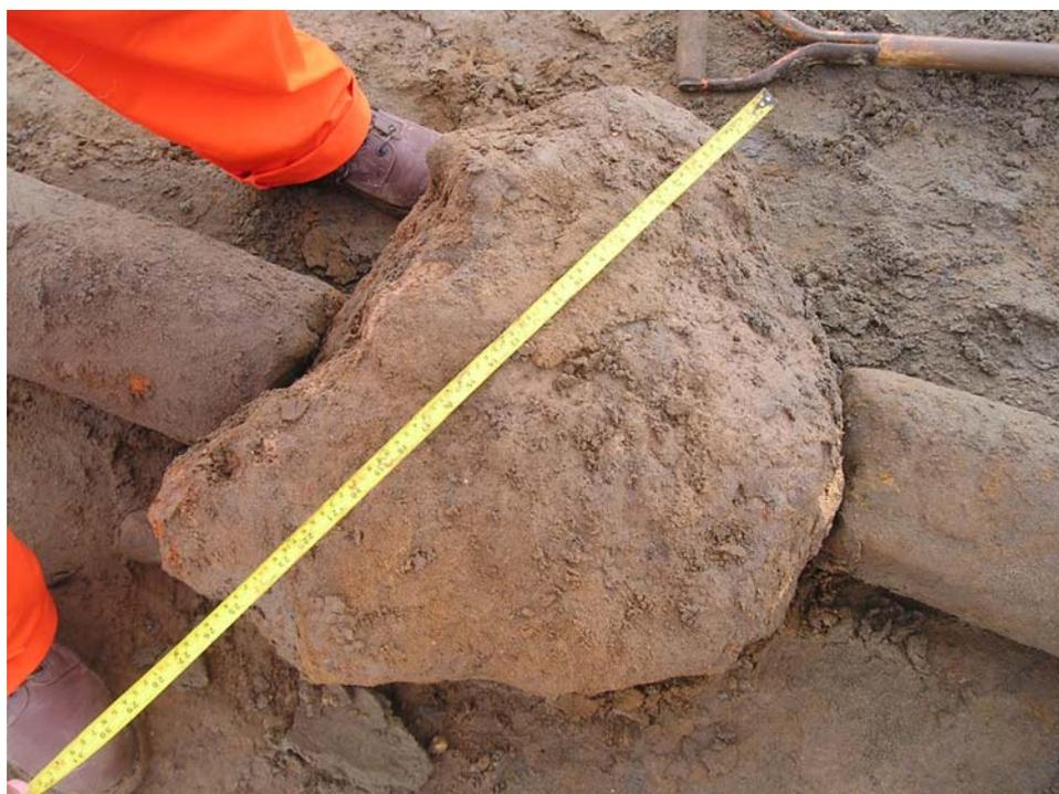
Foto VI-10 Bulbo de mortero excavado (diámetro medio de 60 cm) correspondiente al tramo inyectado entre 7 - 7.5 m.
