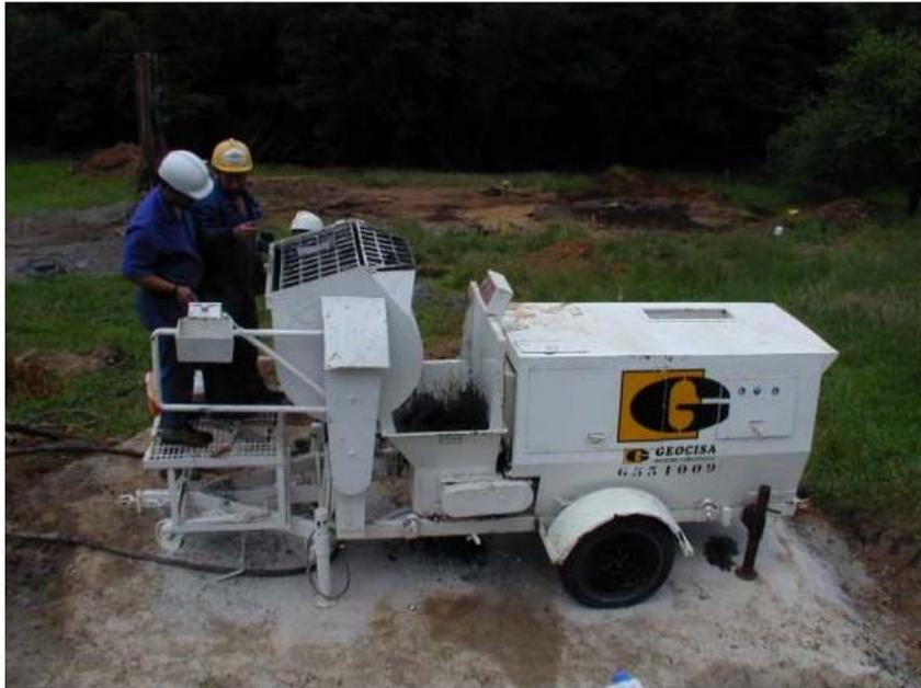
Foto IV-5 Bomba de pistones con mezcladora acoplada.
