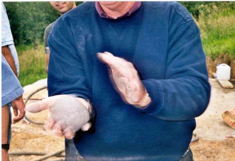
Foto IV-2 Preparación de la pelota de baseball con el mortero anteriormente mezclado.
