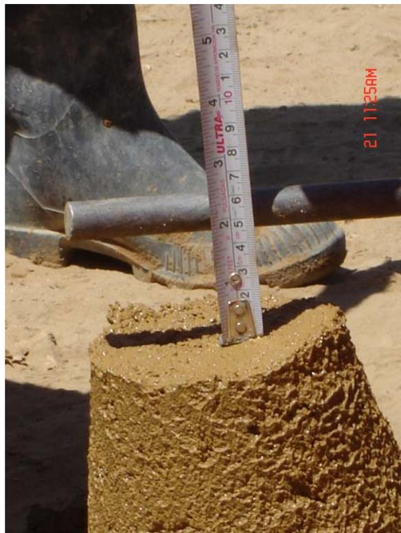
Foto VI-3 Prueba de control del mortero (cono de Abrams de 4.5 cm).
