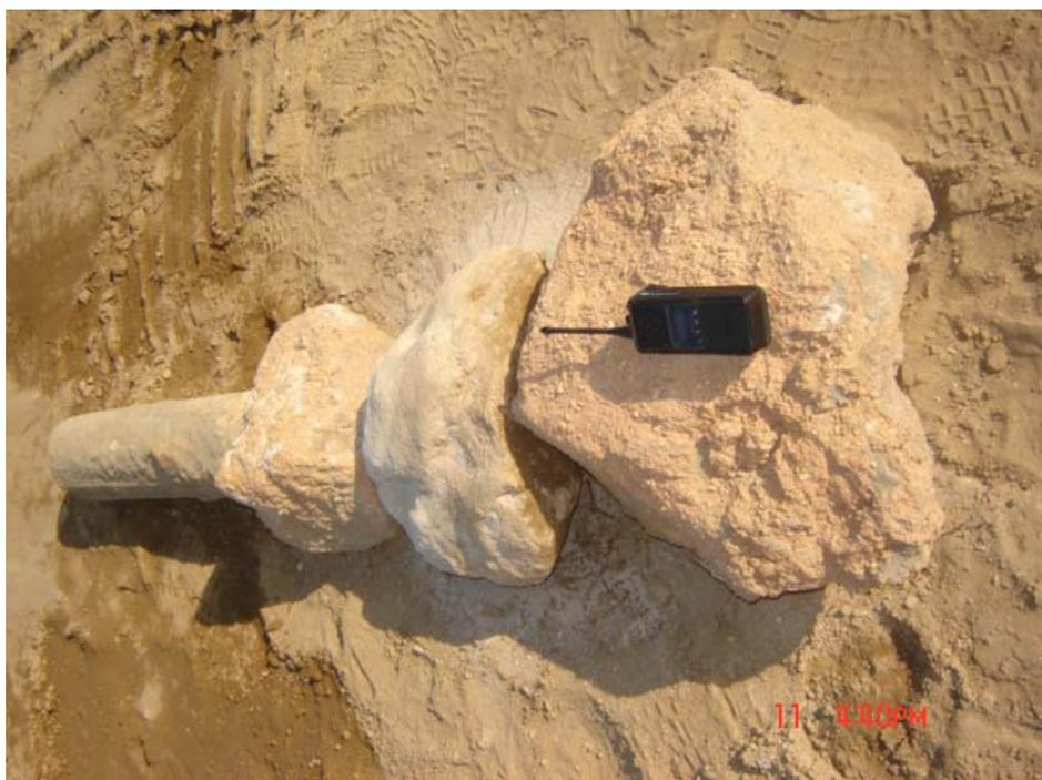
Foto VI-9 Bulbos de mortero del taladro inyectado.
