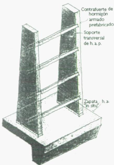
Fig. 9-10. Esquema del muro. (PRETASA)
