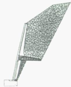
Fig. 9-6. Muro con plataforma estabilizadora (TENSITER)
