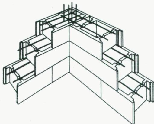
tical recogerá varias hiladas. El refuerzo se completa rellenando el hueco interior de los bloques de hormigón.
