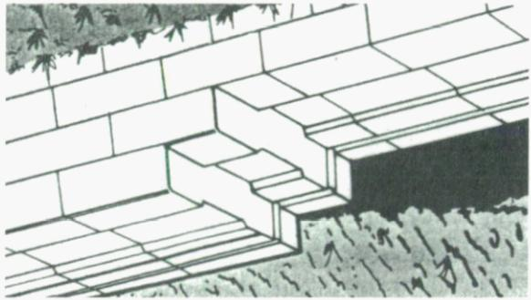
3. Colocación de las sucesivas hileras, se va levantado el muro en toda su altura, dando al paramento distintas densidades de ajardinamiento (dependiendo del tamaño de los huecos que existan).
