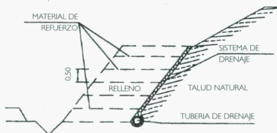
Fig. 6-4. Ubicación del sistema de drenaje
