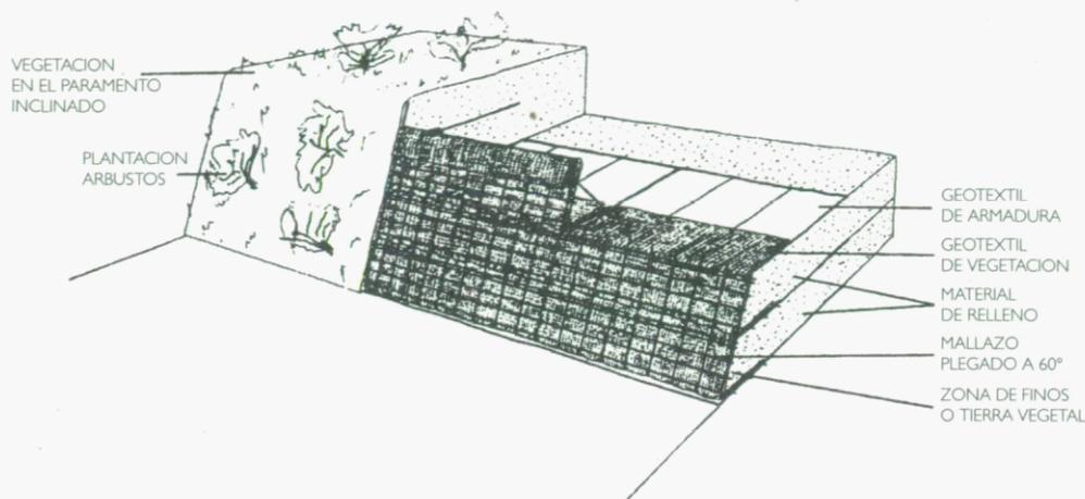
Fig. 6-2. Elementos constructivos (Sistema TEXTOMUR)
