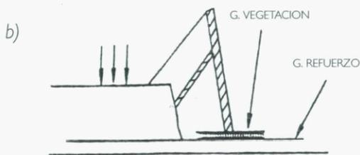
6. Colocación y compactación de la tierra vegetal. En determinadas ocasiones se puede primero compactar la tierra vegetal y posteriormente el material de relleno.
