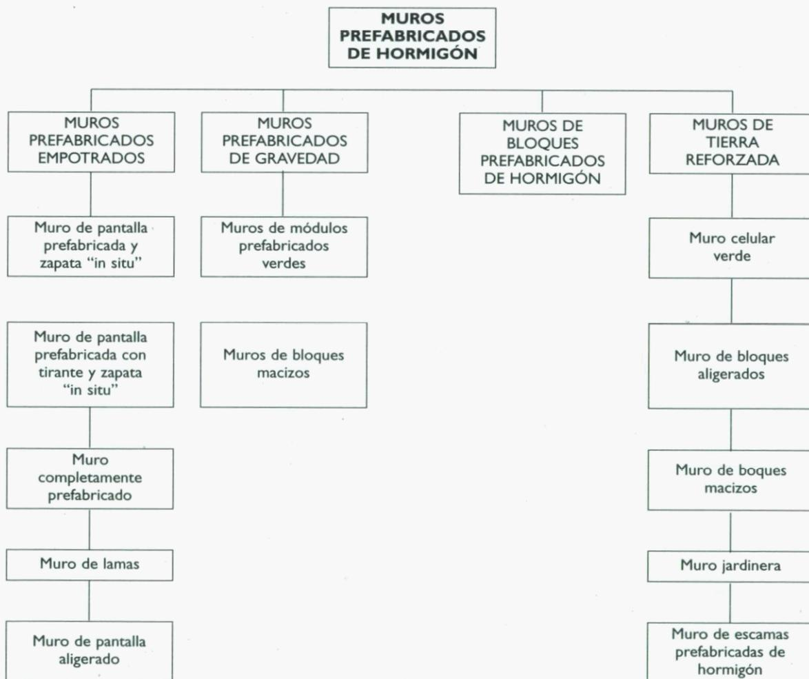
Tabla 6. Clasificación de muros prefabricados con elementos de hormigón
