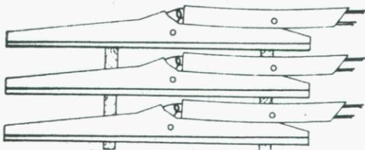
mión si aún no se ha descargado la pieza, girando el tirante hasta formar unos 45°. En ese momento se tendrán enfrentados los bucles tanto del tirante como de la pieza prefabricada, es ahora cuando se introduce el pasador de acero.
