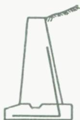
Fig. 3.5. Muro de semigravedad
