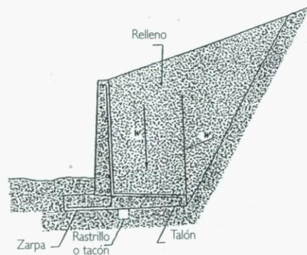
Fig. 3.2. Muro de hormigón armado
