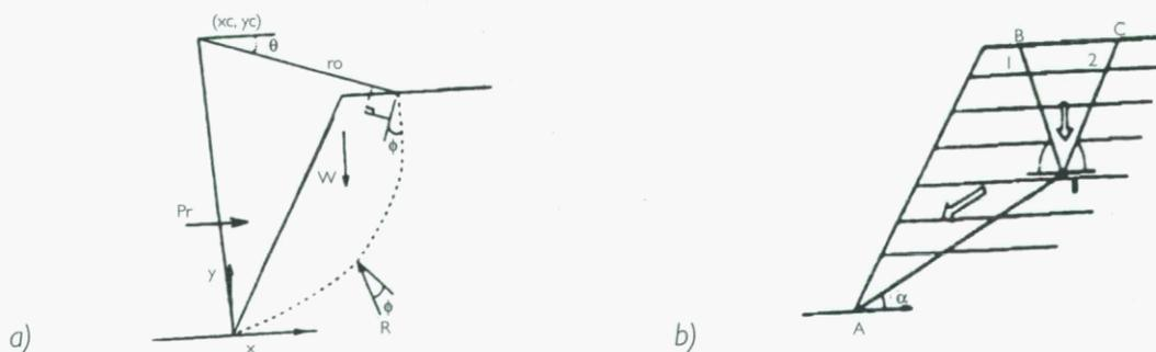
Fig. 6-9. Métodos de empuje activo: a) espiral logarítmica; b) doble cuña
