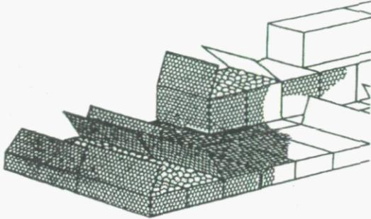
Fig. 7-11. Esquema muro de gaviones
