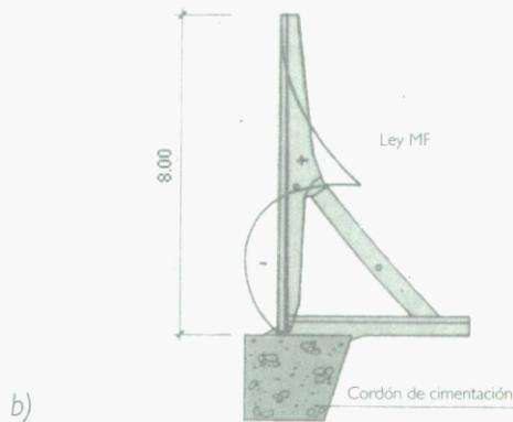
das al momento de empuje de tierras y sobrecargas, muy elevada. La utilización del tirante originará que estos esfuerzos, tanto los del muro como los de la cimentación, se reduzcan de forma sensible.
