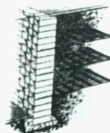
5. Repetición de los últimos tres pasos (colocación de las sucesivas hiladas de bloques, vertido y compactación del relleno y colocación de refuerzo) hasta completar el muro.
