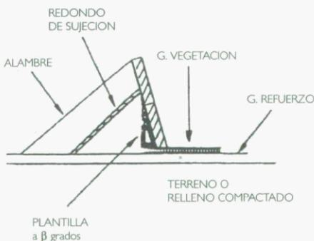
Fig. 6-6. Elementos de montaje (Sistema ARCO SYSTEMS)
