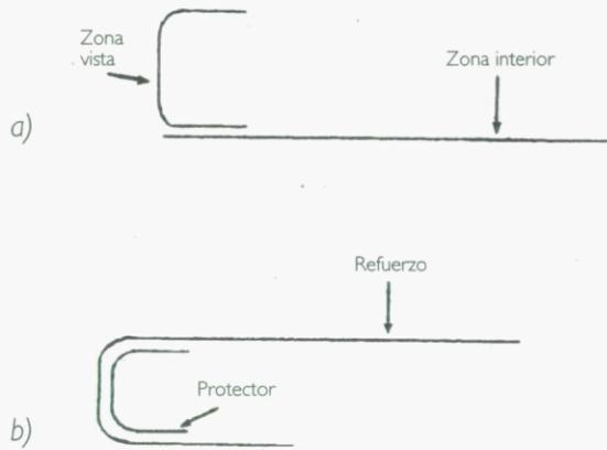
4. Instalación del encofrado en el borde del terraplén, dependiendo su altura de la tongada de diseño (normalmente se suelen utilizar tongadas de unos cincuenta centímetros).
