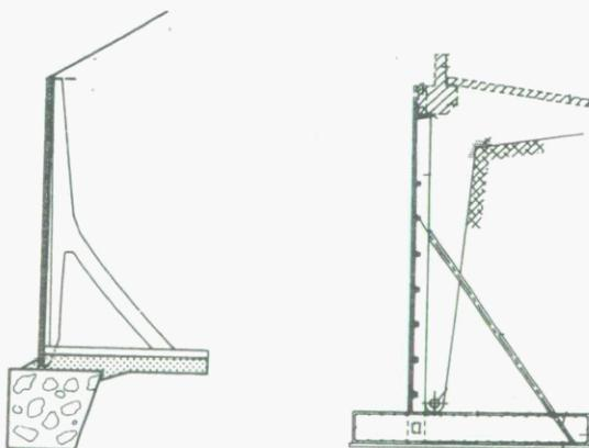
Fig. 9-5. Muros de pantalla prefabricada con tirante y zapata "in situ". (TENSITER y MURO MASTER)
