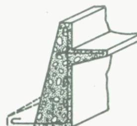
Fig. 3.7. Muros con plataforma estabilizadora
