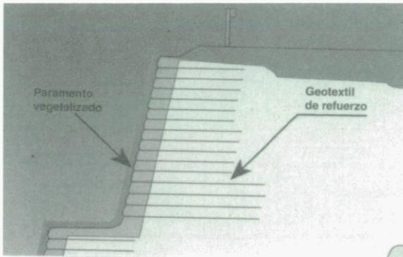
9. Vegetación mediante hidrosiembra directa sobre el paramento exterior del muro. En el caso de la existencia de bermas, la integración en el paisaje se ve reforzada por la plantación de arbustos en ellas.
