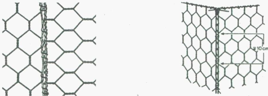
Fig. 7-5. Detalle del amarre y del refuerzo en los bordes
