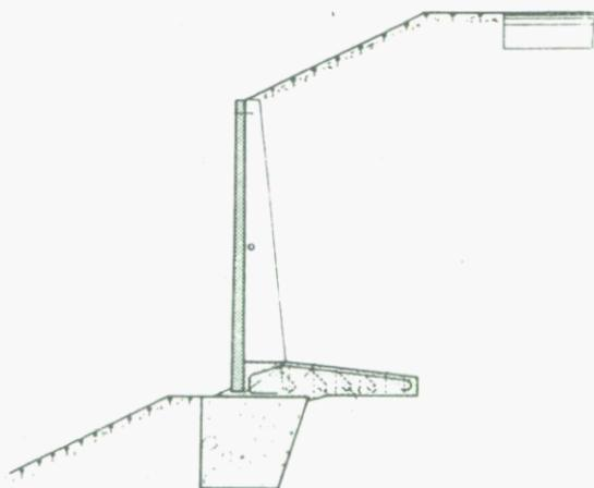
Fig. 9-1. Muro de pantalla prefabricado y zapata "in situ" (TENSITER)
