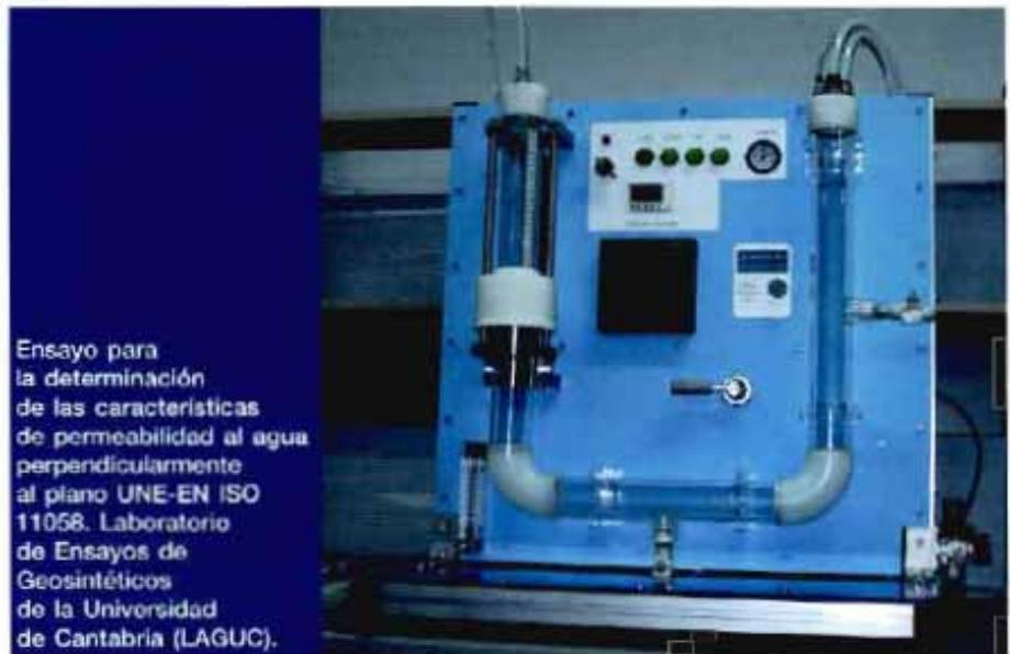
Ensayo para la determinación de las características de permeabilidad al agua perpendicularmente al plano UNE-EN ISO 11058. Laboratorio de Ensayos de Geosintéticos de la Universidad de Cantabria (LAGUC).
