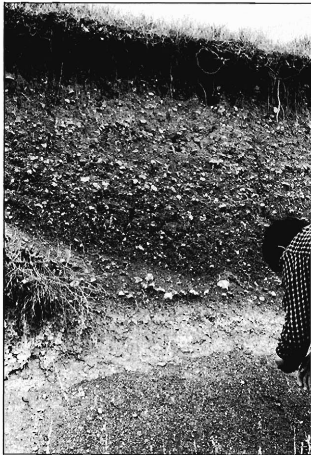
Foto 9.— Recubrimiento coluvial de arcillas con cantos calizos sobre las margas del grupo 321fl.
