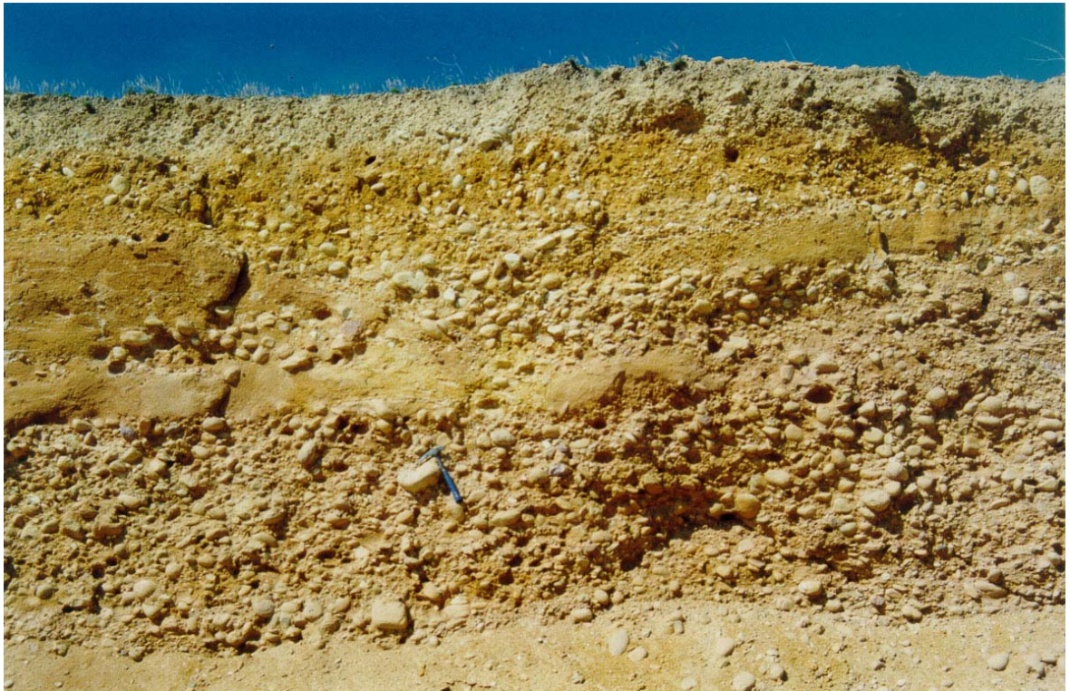
FOTO N° 32. Aspecto que presentan los depósitos de gravas y arenas del aluvial finineógeno o "raña", en las proximidades del P.K. 112+300 de la CN-611.
