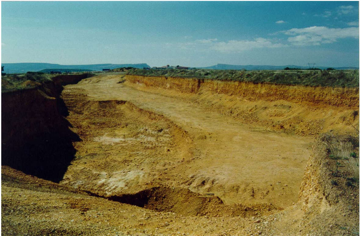
FOTO N° 61. Explotación intermitente de áridos en las proximidades del P.K. 112+300 de la CN-611. Se extraen gravas silíceas de la "raña" (grupo 322).
