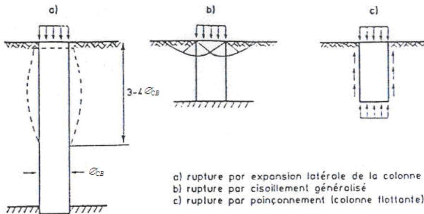
**Figure n° 4 : Type de rupture**
