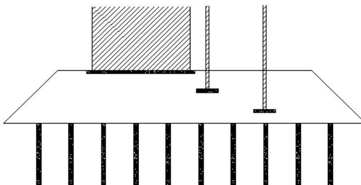
**Figure n° 3 : Implantation des colonnes sous un remblai**
