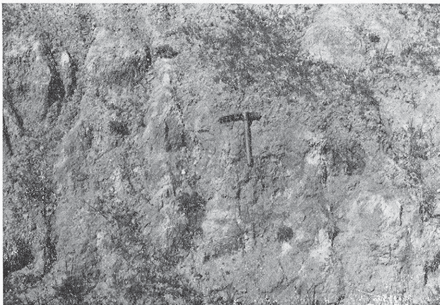
Fot. 34. Detalle de los materiales de la facies Tierra de Campos junto al pueblo de Vezdemarban con manchas dispersas de carbonatos en su masa arcillo-arenosa.
