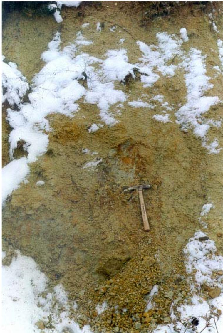
*Figura 3.38. Limos masivos del grupo (312a), en un pequeño talud situado en el P.K.1,5 de la carretera de Zamora a La Hiniesta.*
