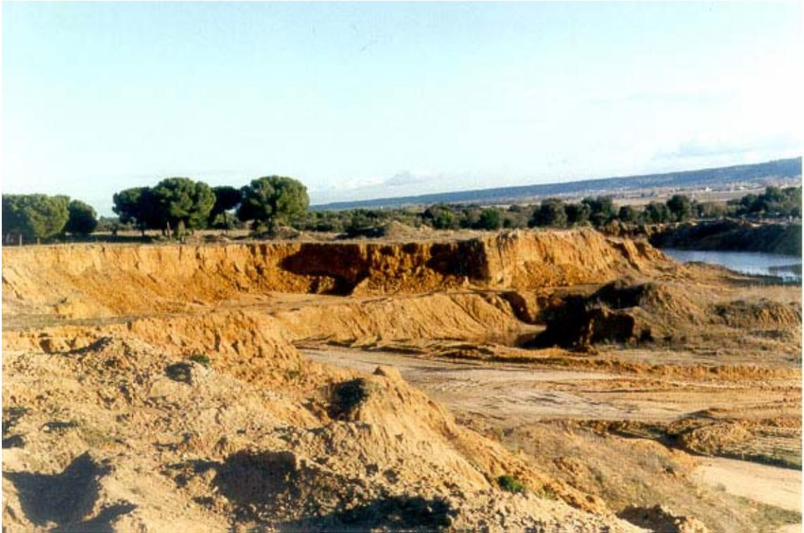
*Figura 5.7. Explotación de arenas y gravas del grupo (312e), situada junto a al P.K. 72 de la carretera N-122.*
