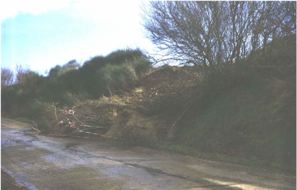
Figura 3.30. Deslizamiento rotacional en un talud de baja altura realizado en el grupo (312a), en las proximidades de la localidad de Peleas de Abajo (Hoja 397-2).
