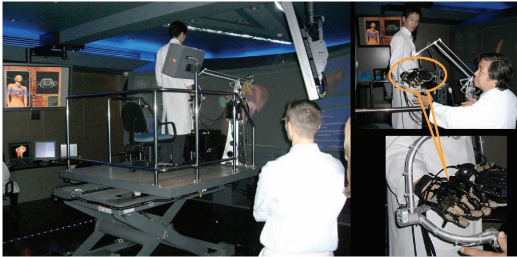
Figura 4.4. Interfaz y sistemas hápticos preparados para la realización de una cirugía a distancia en el laboratorio del Prof Dr. Sci. Dr Eng & Dr. Med. Naoki Suzuki, del Institute for high dimensional medical imaging de la Jikei University School of Medicine Tokio, Japón.
