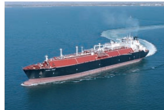
Figura 8.15. Gasero Madrid Spirit de 138.000 m 3 de capacidad y tanques de membrana.
