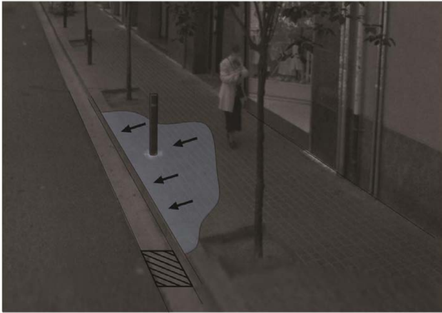
Figura 2-11-a. Transformación lluvia-caudal , escorrentía sobre acera
