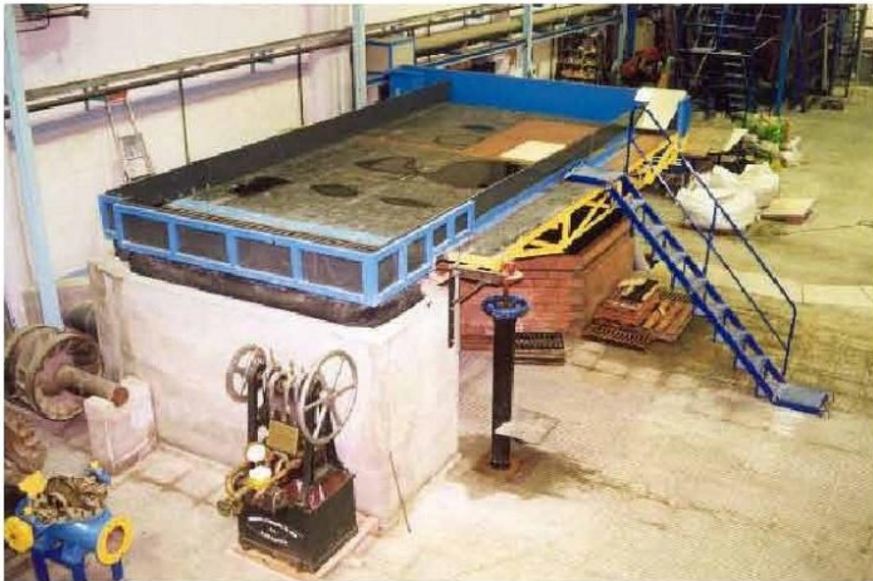
Figura 3-3. Plataforma de ensayo para imbornales
