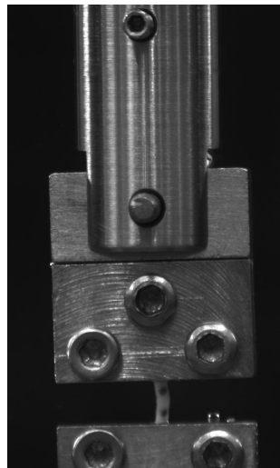
Figura 3.9: Montaje de una probeta rectangular en mordazas
