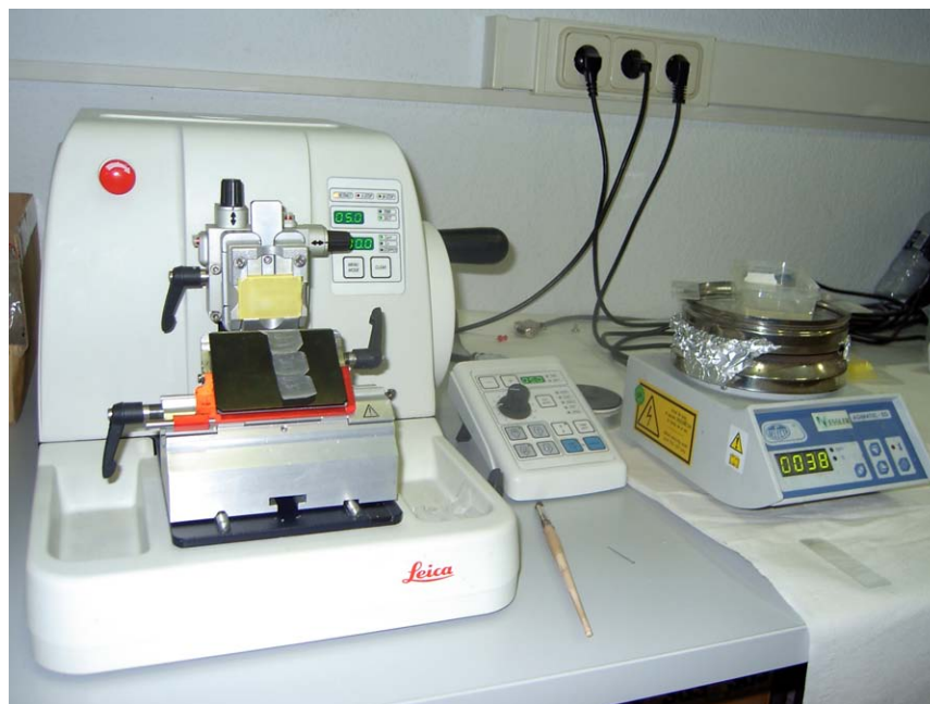
Figura D.2: Corte de la muestra con el microtomo
